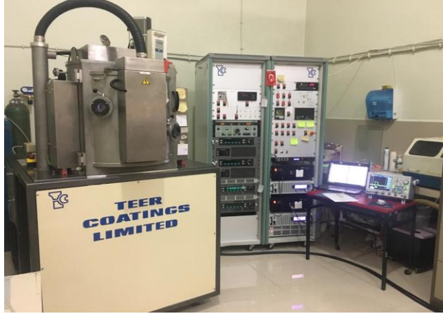
Şekil 3.1. Kapalı alan dengesiz manyetik alanda sıçratma sistemi.
