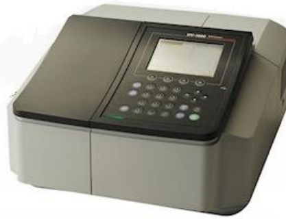
Şekil 4.4. UV-VIS 1800 shimadzu spektrofotometre cihazı
