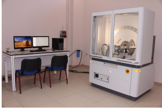
Şekil 4.2. Panalytical empyrean X-ışınları kırınım cihazı
