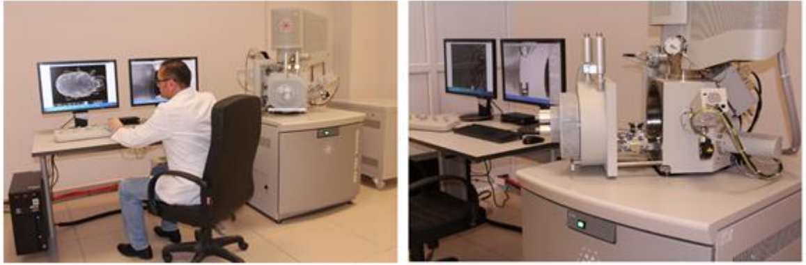
Şekil 4.3. EDAX dedektörüne sahip taramalı elektron mikroskobu (SEM)
