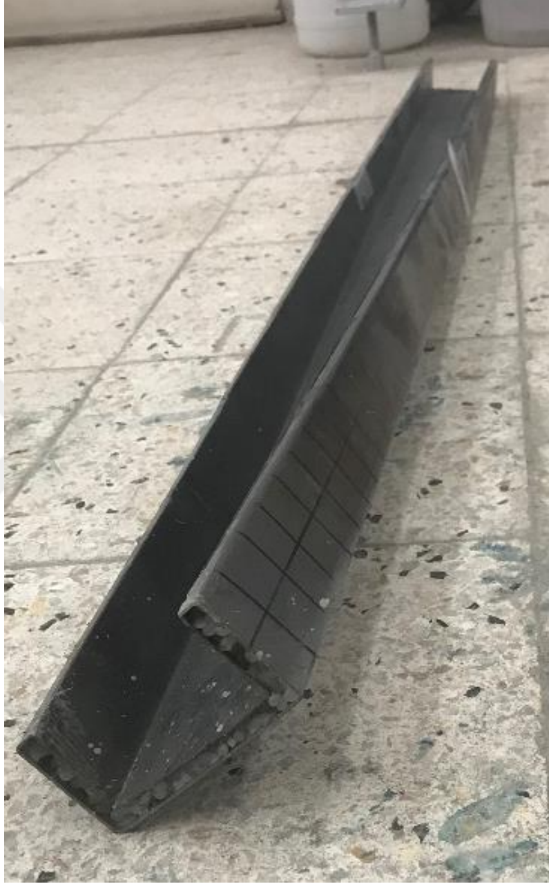
Őekil 5.38. U10 profili burulma deneyi sonrası
