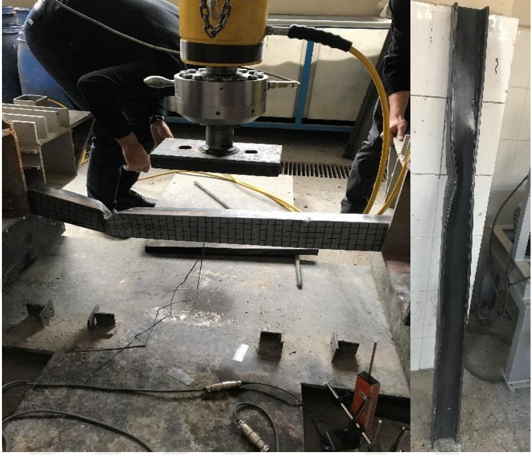
Şekil 5.10. U3 profili dört noktalı eğilme deneyi sonrası
