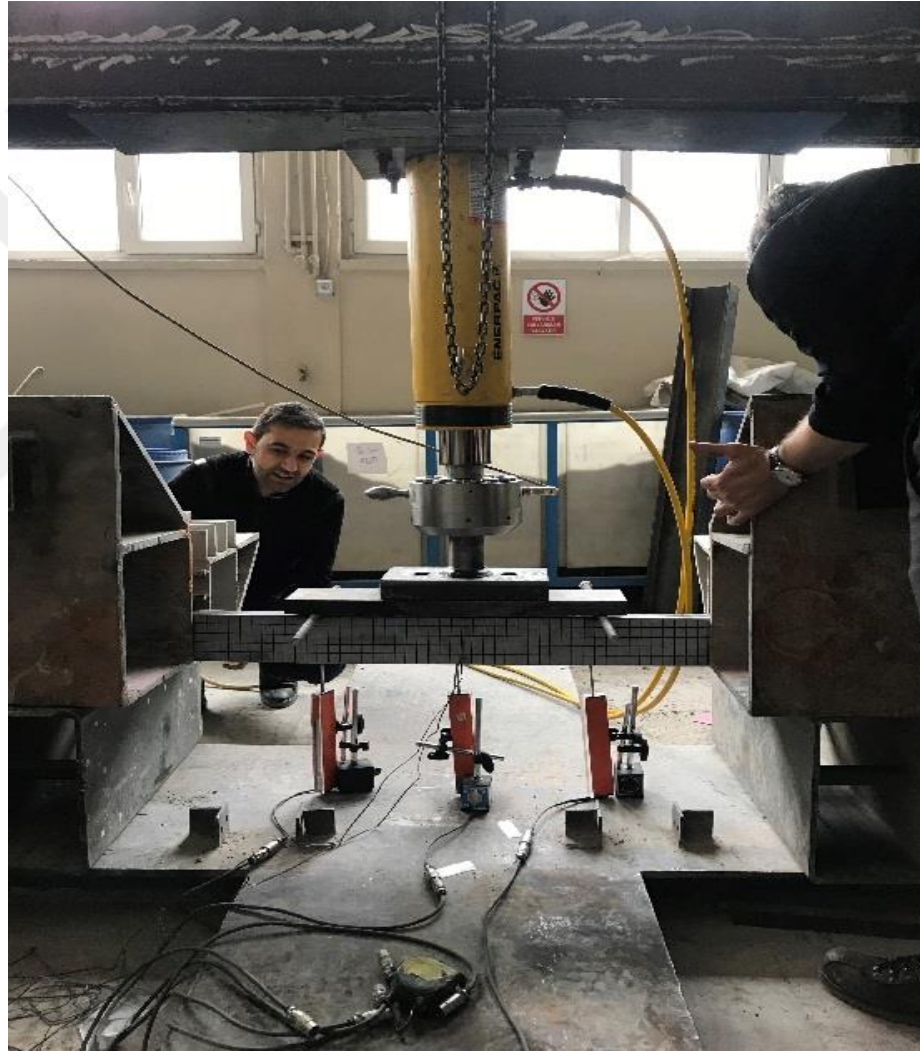
Şekil 5.9. U3 profili dört noktalı eğilme deneyi
