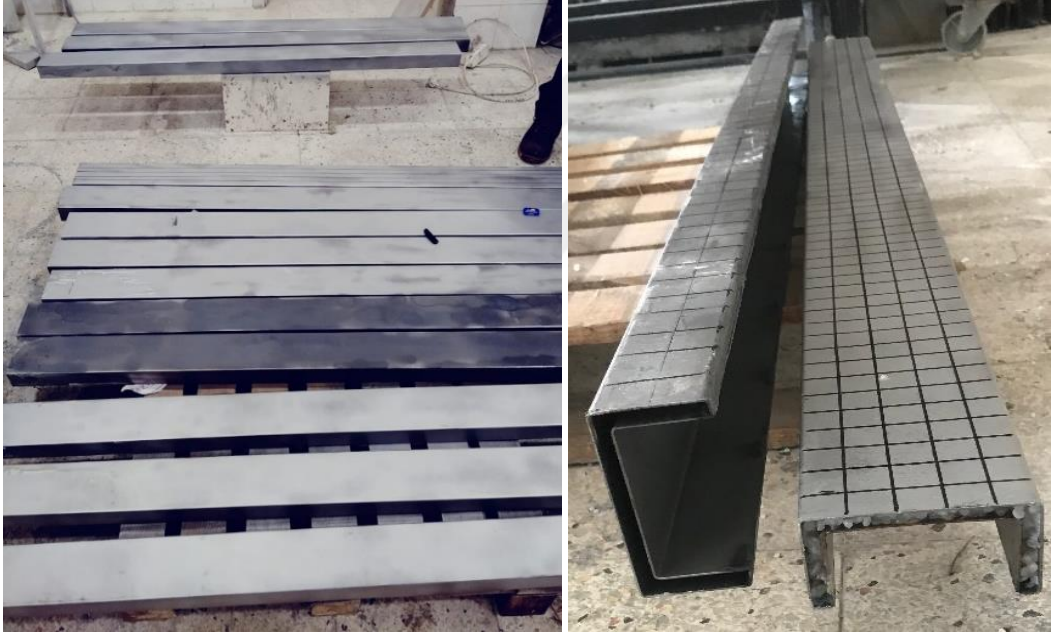
Şekil 4.18. Boyanmış ve ağ yapısı oluşturulmuş U100 profiller
