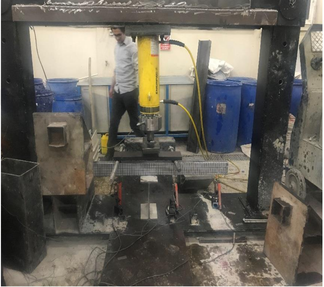
Şekil 5.25. U7 profili kesme deneyi
