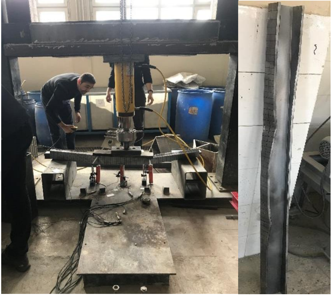
Şekil 5.2. U1 profili dört noktalı eğilme deneyi sonrası
