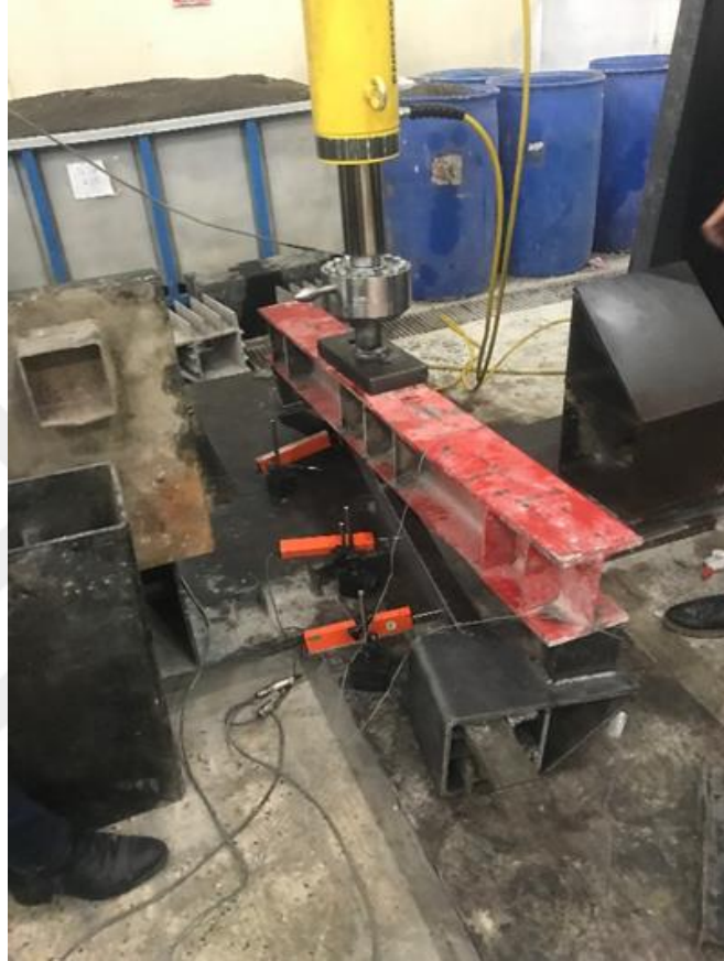
Şekil 4.34. Burulma deneyi LVDT yerleşimi
