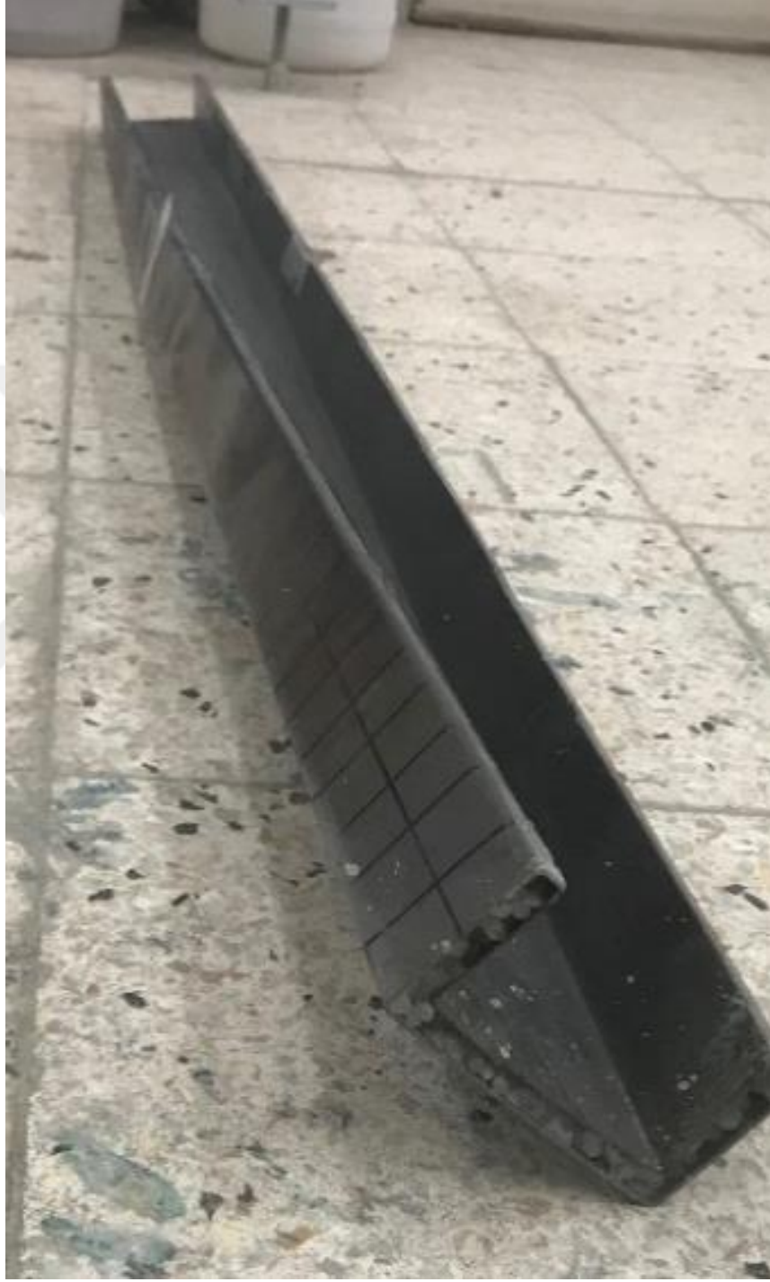
Şekil 5.34. U9 profili burulma deneyi sonrası
