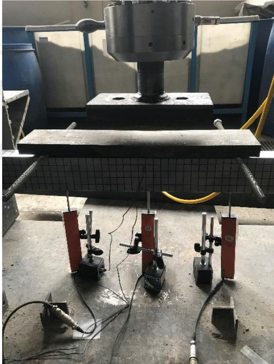
řekil 5.5. U2 profili drt noktalı eęilme deneyi
