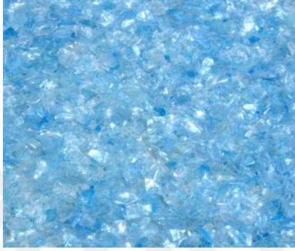
Şekil 2.3. Çalışmada kullanılan öğütülmüş atık pet (Ahmadabad,2014)
