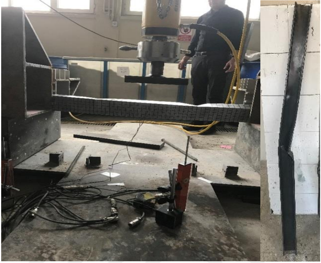
Şekil 5.6. U2 profili dört noktalı eğilme deneyi sonrası
