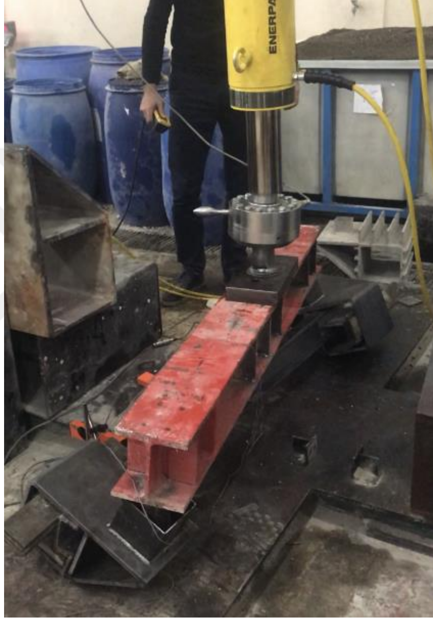
Şekil 4.35. Burulma deneyinden bir görünüm
