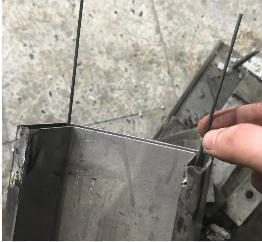
Şekil 4.13. Karbon fiber çubukların yerleştirilmesi
