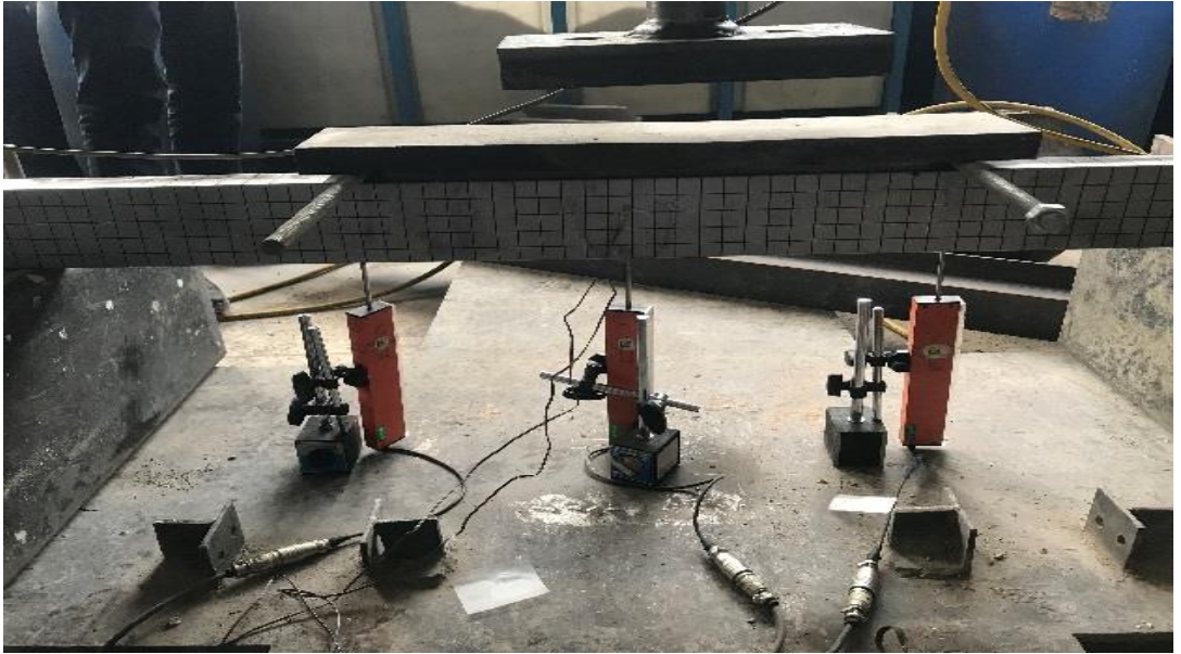
Şekil 4.26. Dört noktalı eğilme deneyi LVDT yerleşimi
