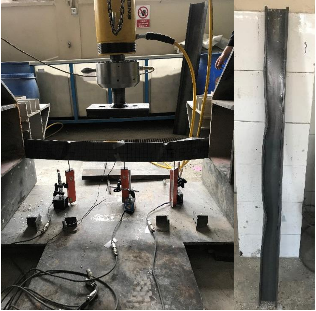
Şekil 5.14. U4 profili dört noktalı eğilme deneyi sonrası
