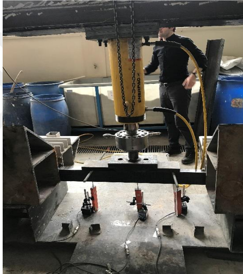
Şekil 5.13. U4 profili dört noktalı eğilme deneyi
