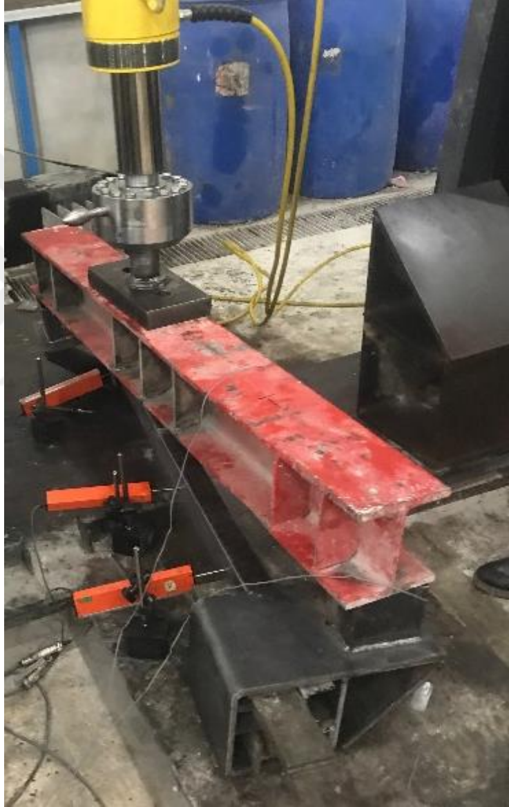
Şekil 5.33. U9 profili burulma deneyi
