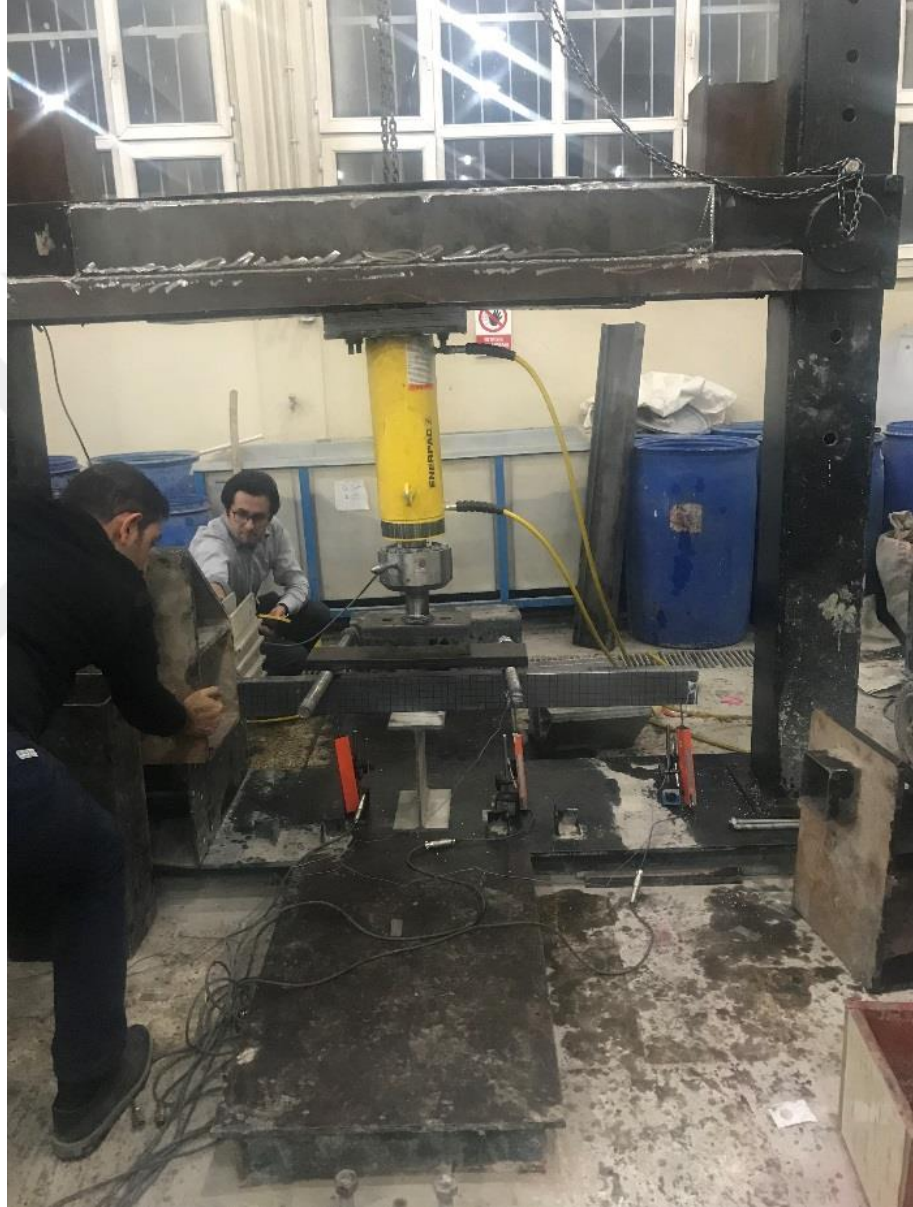
Şekil 5.29. U8 profili kesme deneyi
