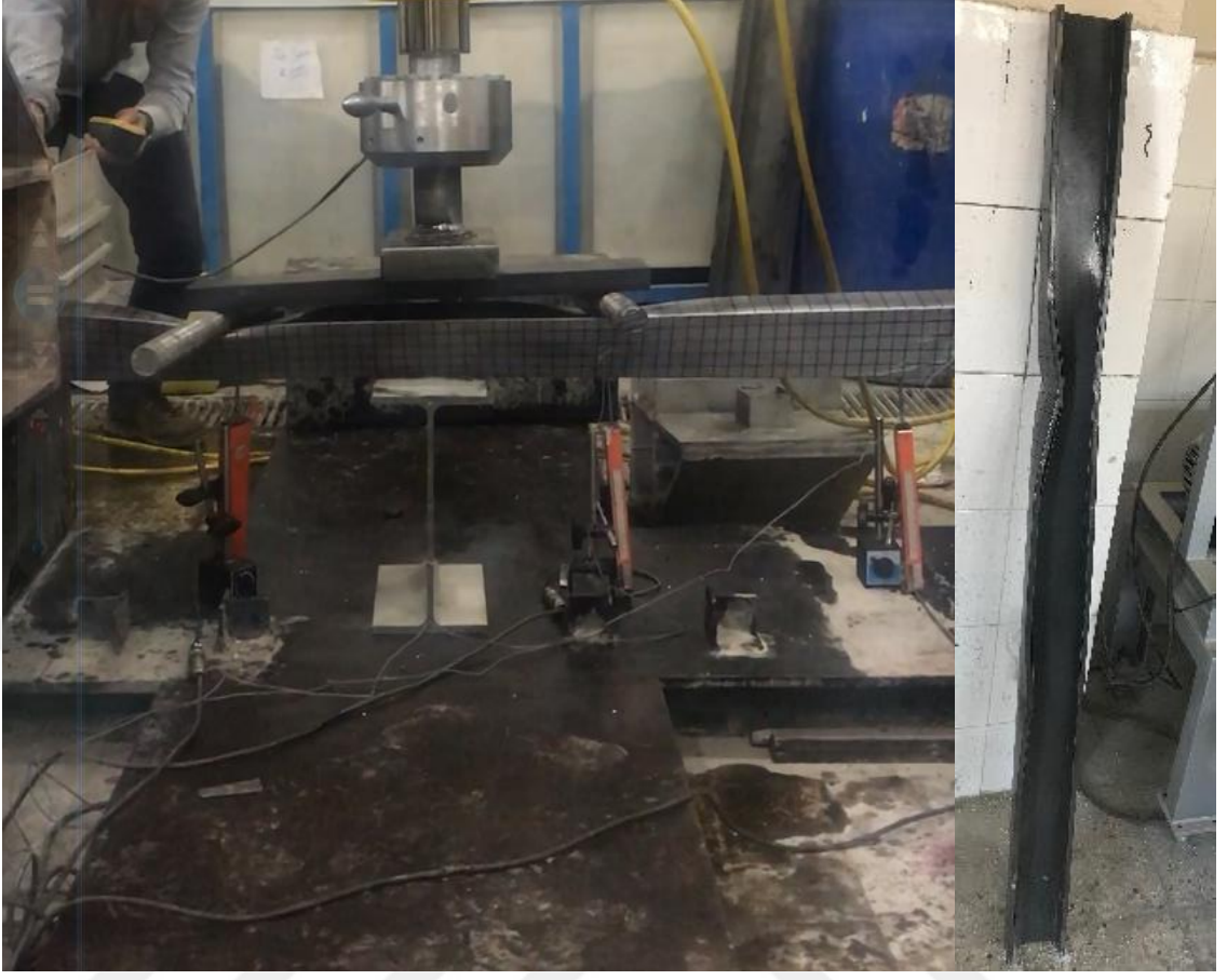
Şekil 5.26. U7 profili kesme deneyi sonrası
