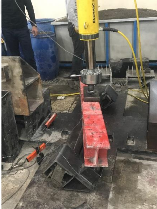
Şekil 5.37. U10 profili burulma deneyi
