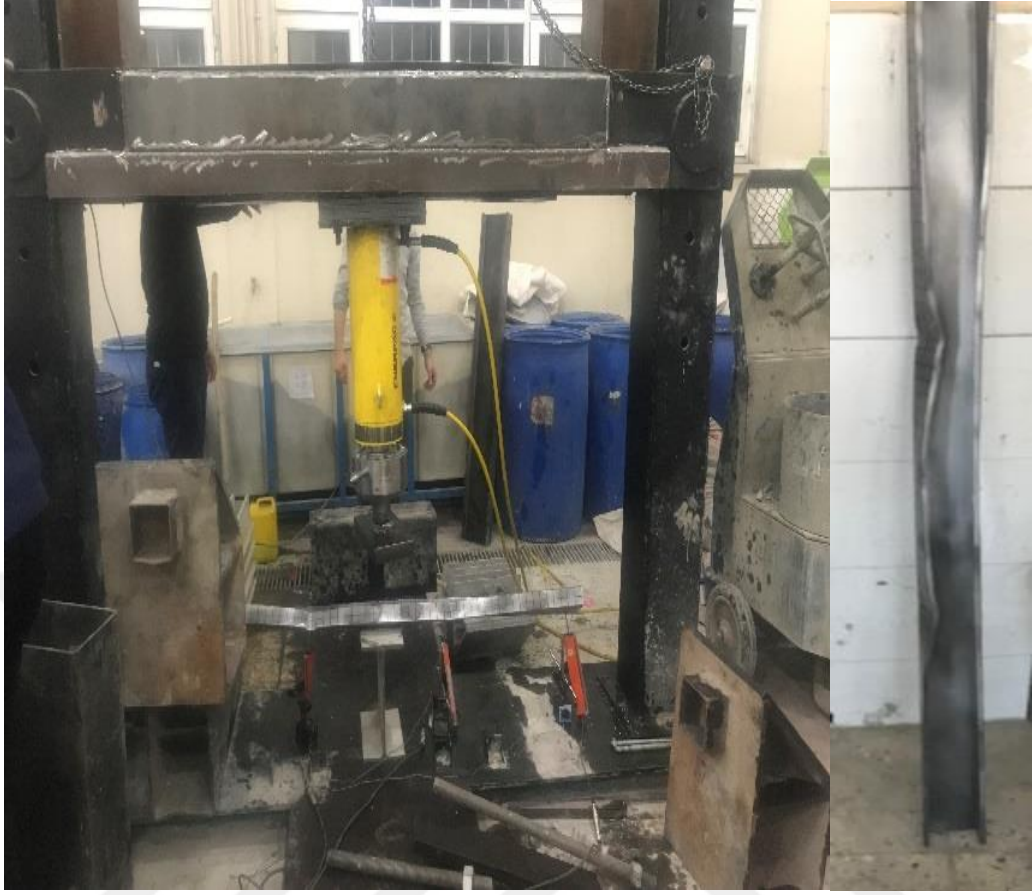
Şekil 5.18. U5 profili kesme deneyi sonrası
