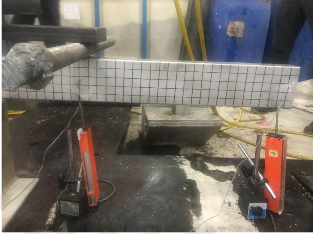
Şekil 4.31. Kesme deneyi strain gauge yerleşimi
