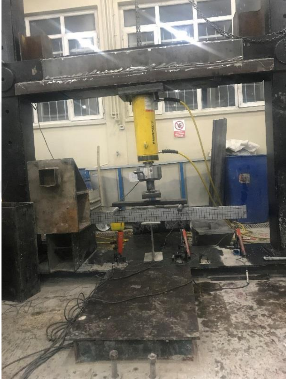
řekil 5.21. U6 profili kesme deneyi
