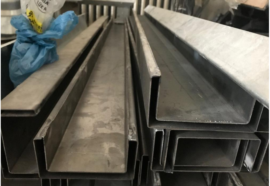
Şekil 4.1. Çalışma kapsamında üretilen hafif çelik U profil
