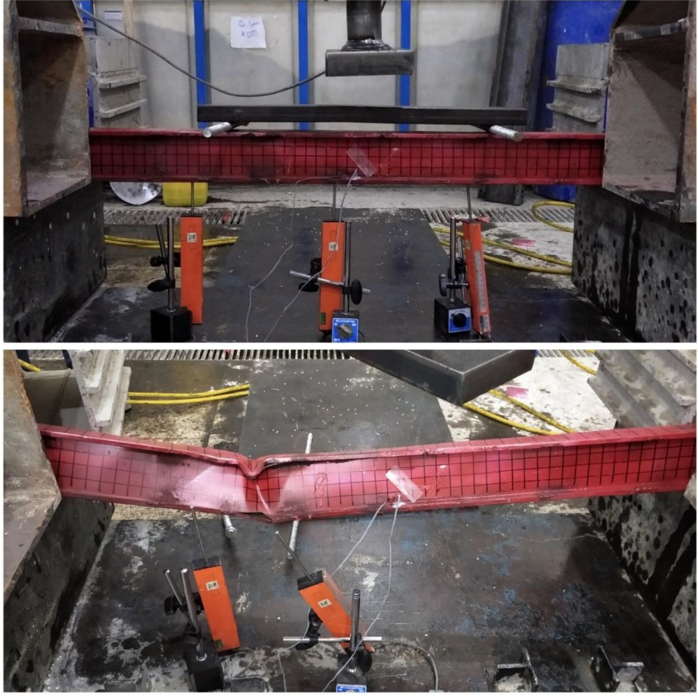
Şekil 5.18. Dört noktalı eğilme deneyi uygulanan I4 profilinin ilk ve son hali
