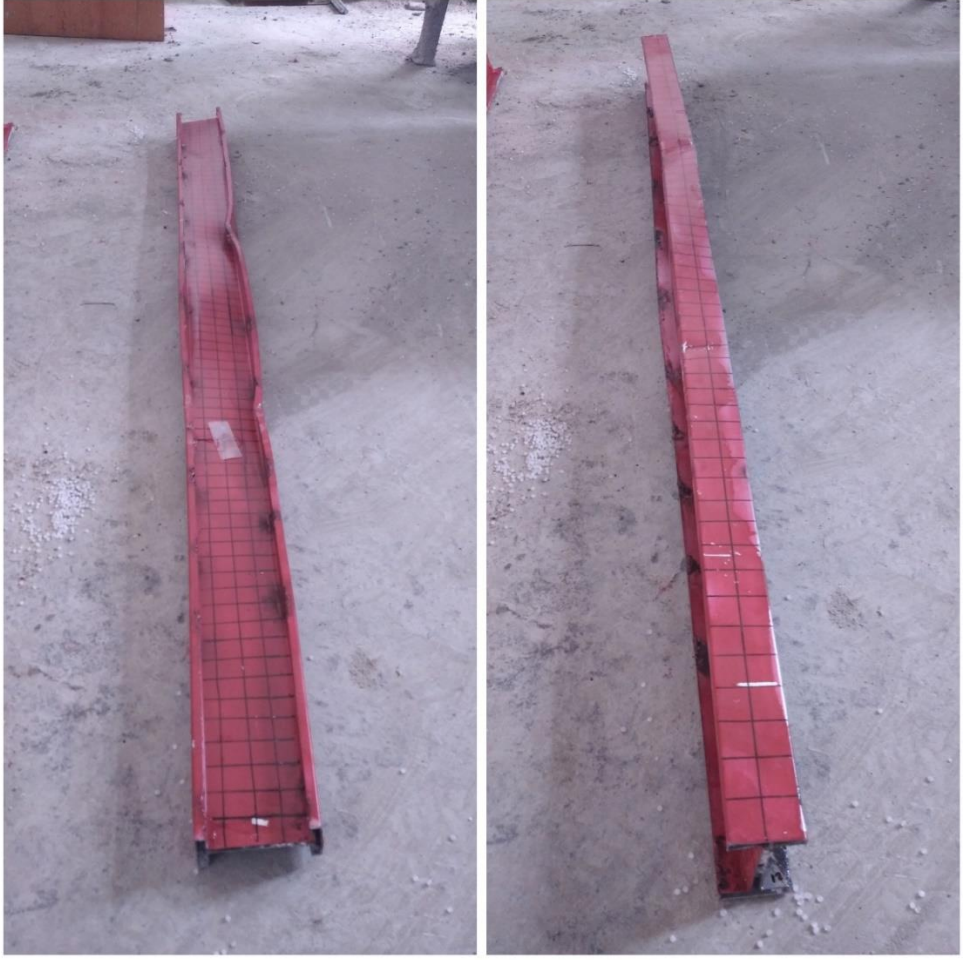
Şekil 5.41. I8 profilinin kesme deneyi sonrasındaki hali
