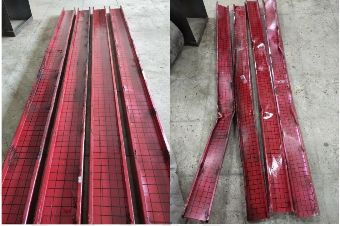
Şekil 5.24. I1, I2, I3, I4 deney profillerinin deneyden önceki ve sonraki halleri
