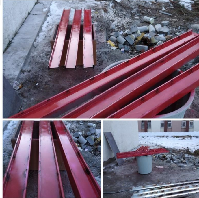
Şekil 4.7. I100 profil numunelerinin boyanması
