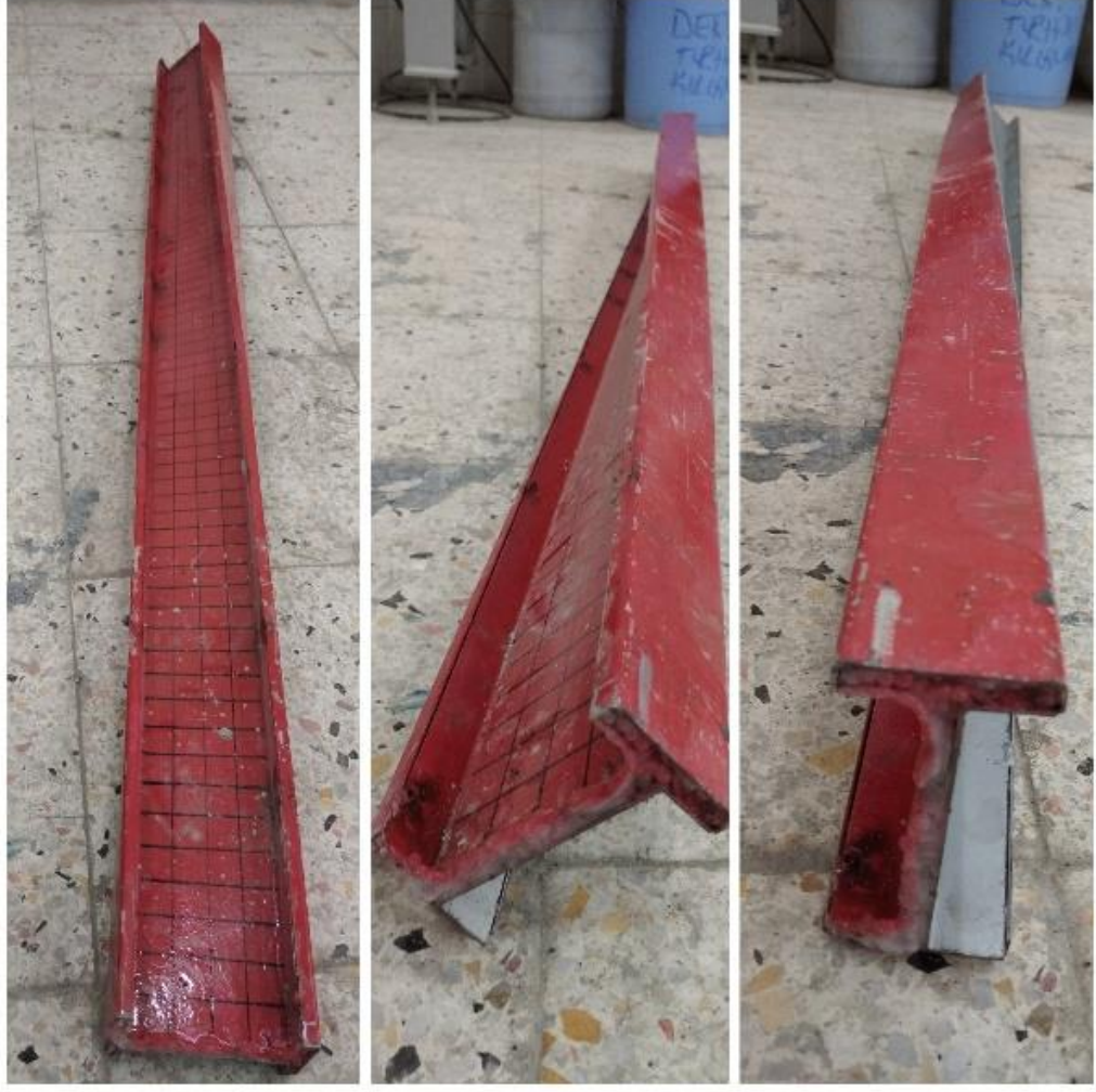
Şekil 5.51. Burulma deneyi sonrasında I10 profilinde meydana gelen burulma
