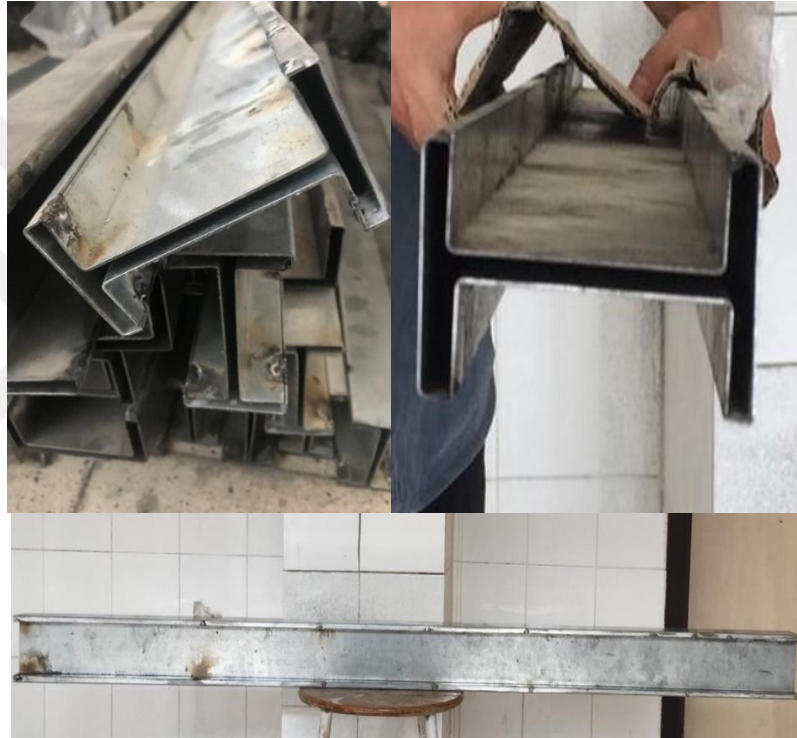
Şekil 4.4. Hafif çelikten imal edilen I100 profiller
