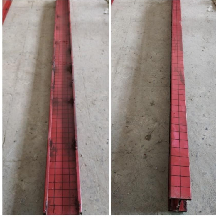
Şekil 5.19. Dört noktalı eğilme deneyi uygulanan I4 profilinin ilk hali
