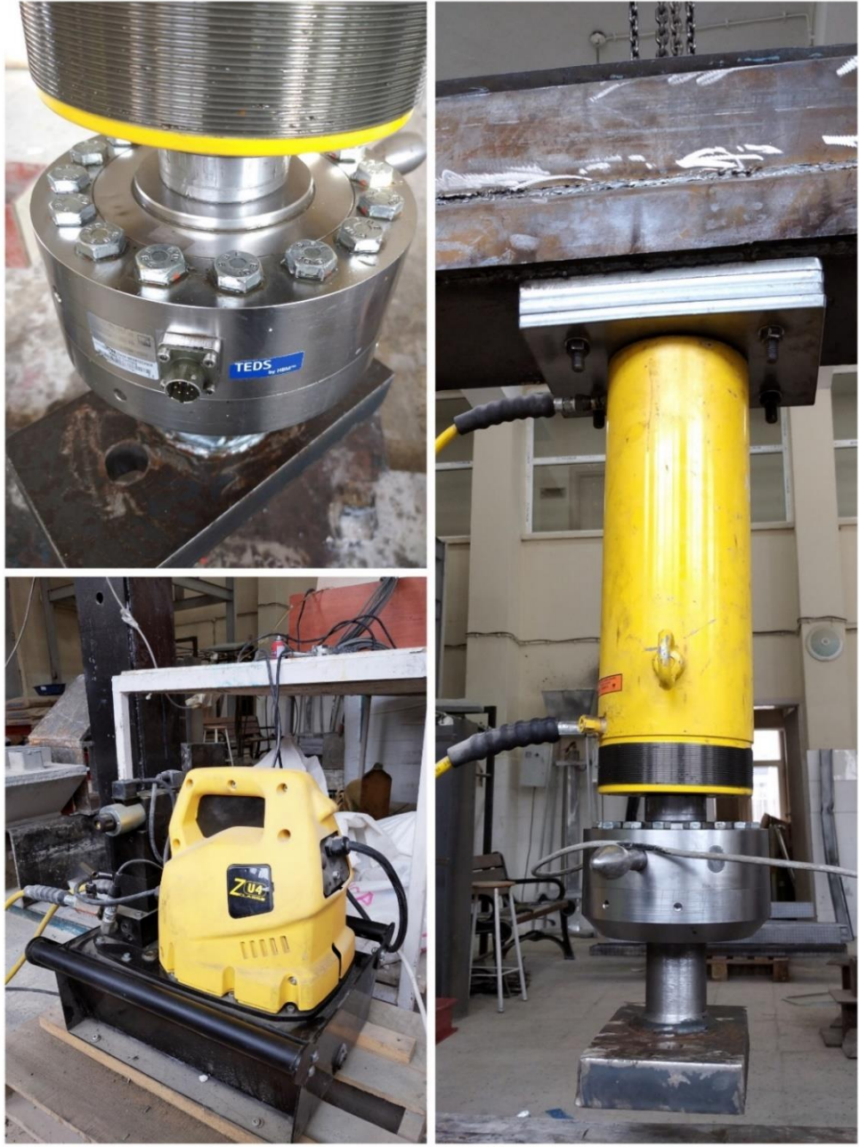
Şekil 4.12 Hidrolik pompa, piston ve yükleme hücreleri
