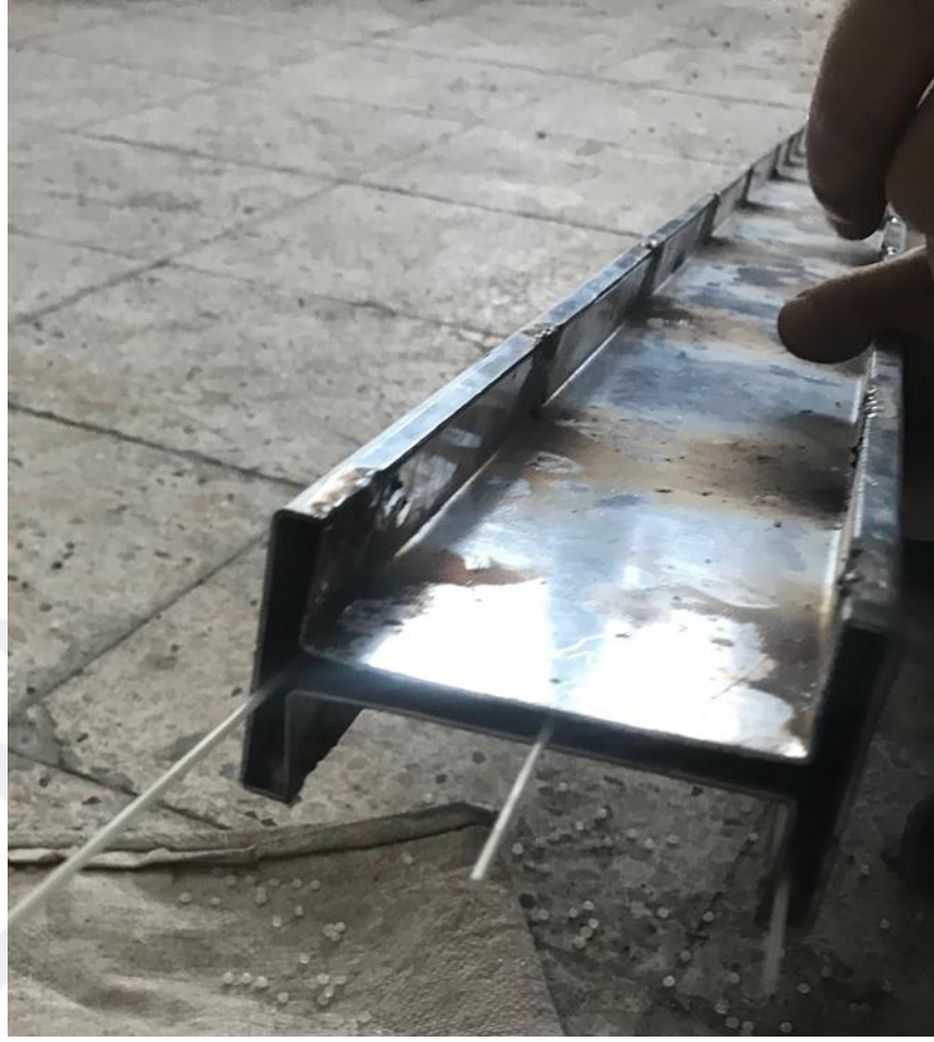
Şekil 5.17. I4 profiline yerleştirilen cam fiber çubuklar
