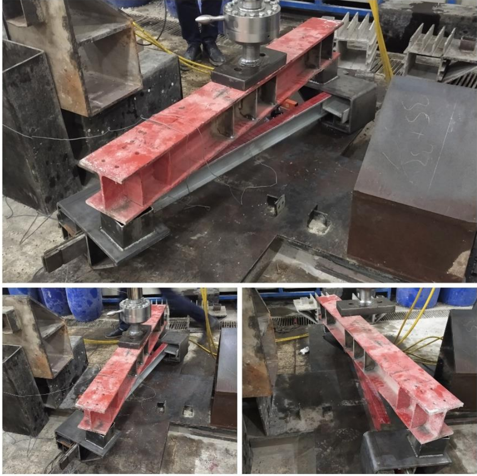
Şekil 5.50. I10 profilinin burulma deney düzeneğine yerleştirilmesi
