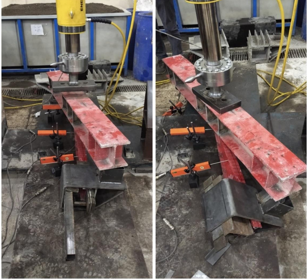
Şekil 5.46. Burulma deney düzeneęine I9 profilinin yerleştirilmesi
