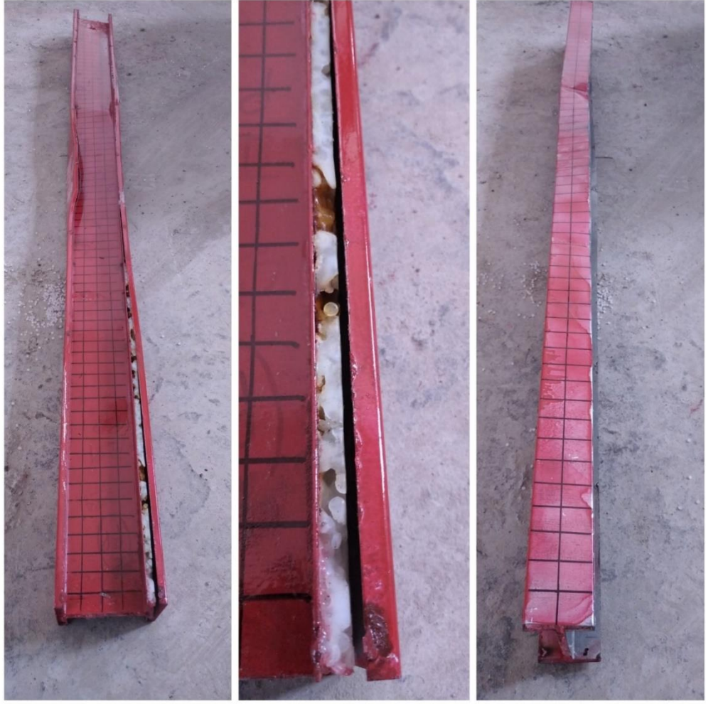
Şekil 5.32. I6 profilinin kesme deneyi sonrasındaki hali
