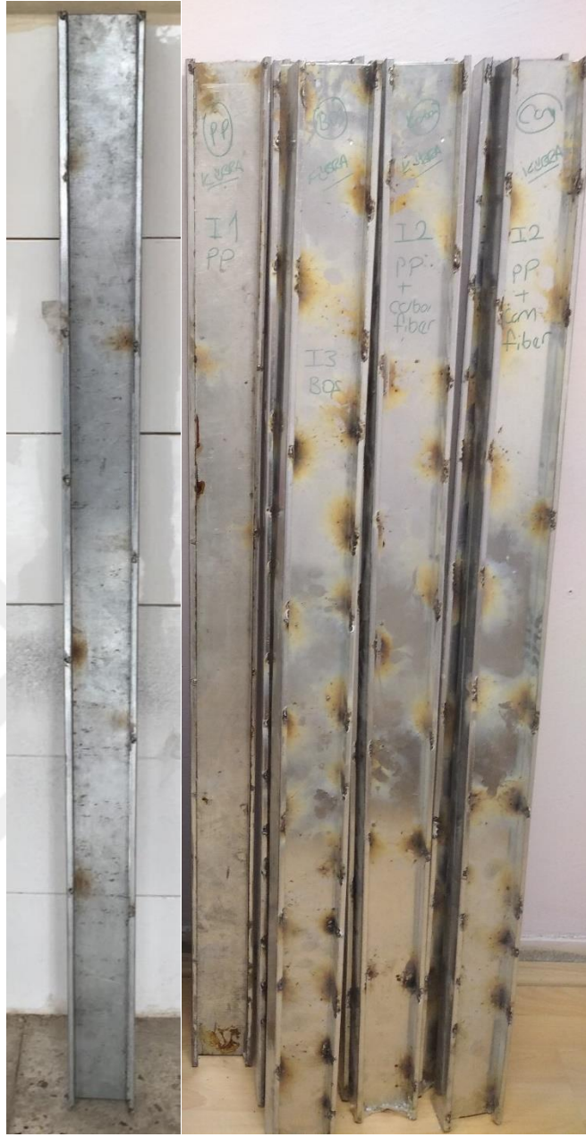
Şekil 4.6. I100 profiller ve bu profillerin içeriklerine göre gruplandırılması
