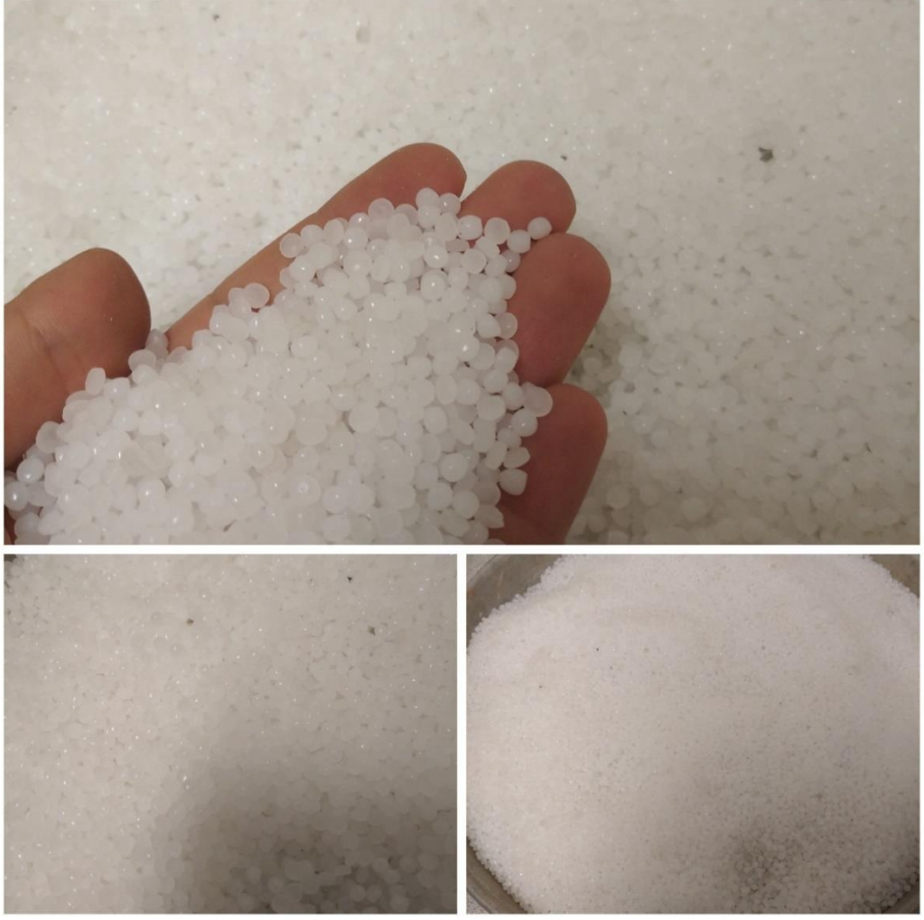
Şekil 4.1. Deneysel çalışmada kullanılan polipropilen malzemesi
