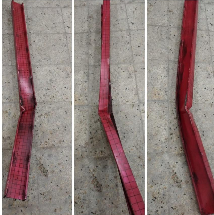
Şekil 5.20. Dört noktalı eğilme deneyi uygulanan I4 profilinin son hali
