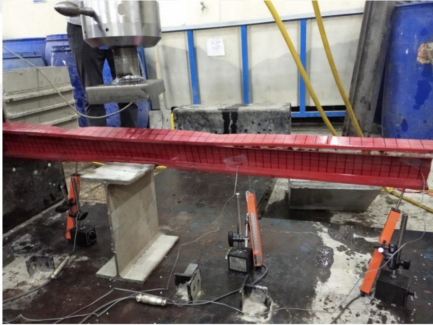
Şekil 5.31. Kesme deneyi sonrasında I6 profili
