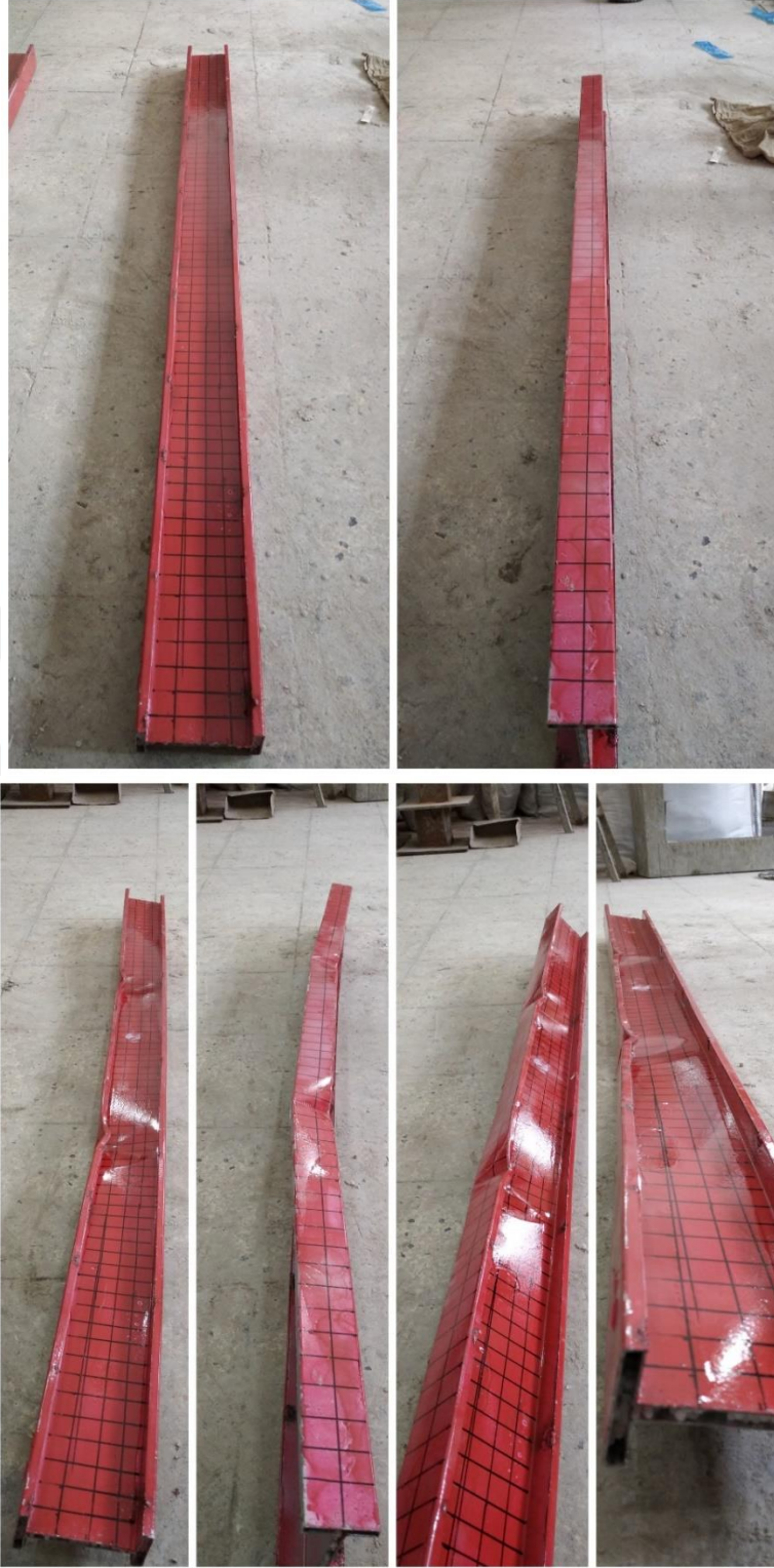
Şekil 5.8. I2 profilinin dört noktalı eğilme deneyi öncesi ve sonrası
