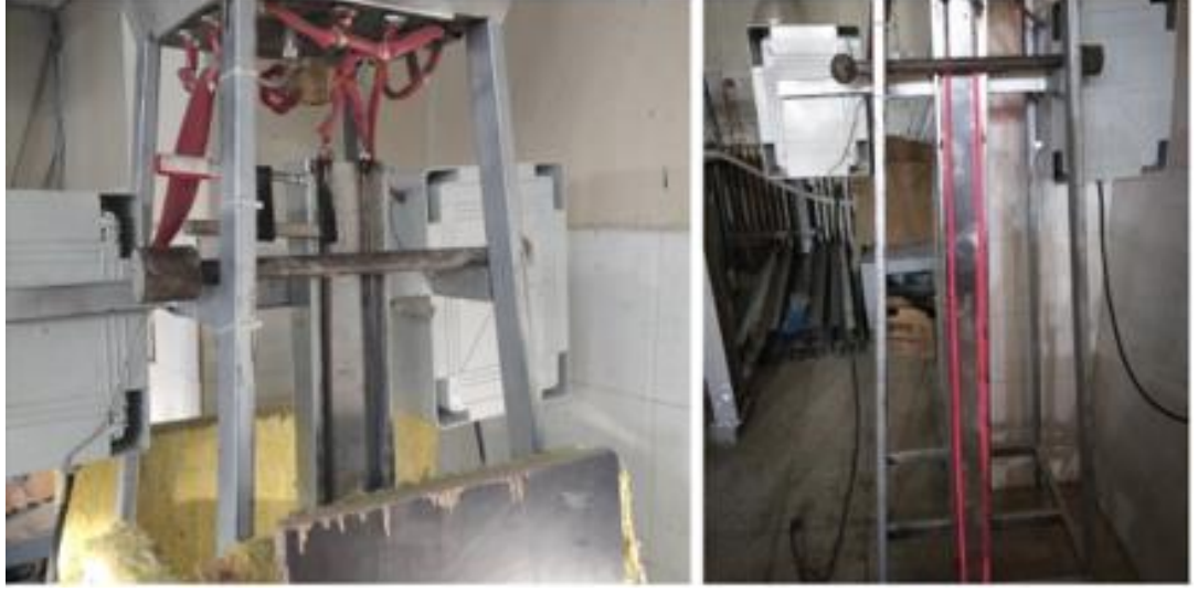
Şekil 4.11. Deney düzeneğinin çalıştırılması ve I100 profillerin sisteme yerleştirilmesi
