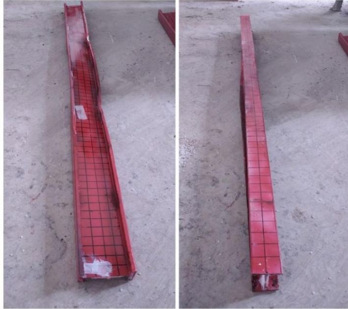
Şekil 5.36. I7 profilinin kesme deneyi sonrasındaki hali
