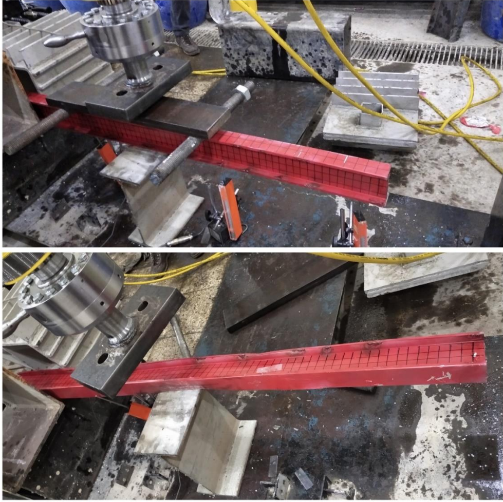
Şekil 5.40. Kesme deneyi uygulanan I8 profilinin ilk ve son hali
