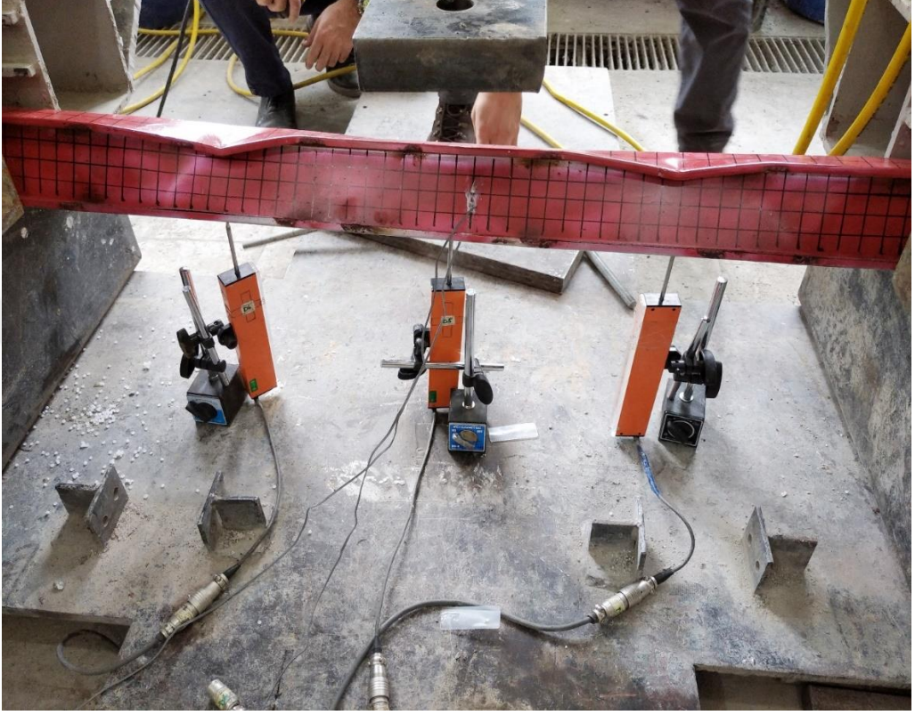
Şekil 5.3. Dört noktalı eğilme deneyi sonrasında I1 profilinin son hali
