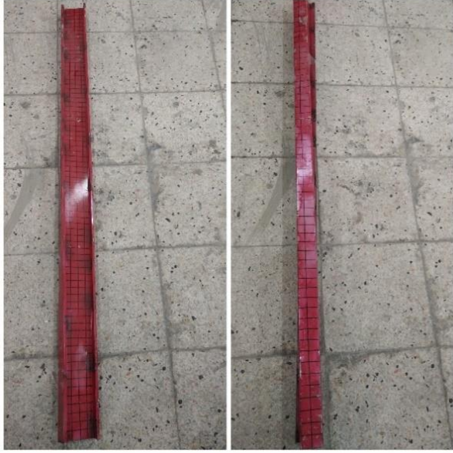
Şekil 5.47. Burulma deneyi sonrasında I9 profilinde meydana gelen burulma
