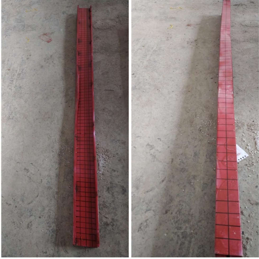
Şekil 5.27. I5 profilinin kesme deneyi sonrasındaki hali
