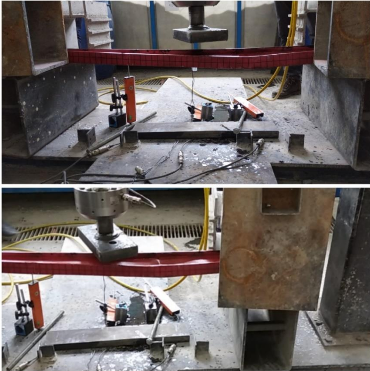
Şekil 5.13. I3 profiline uygulanan dört noktalı eğilme deneyi
