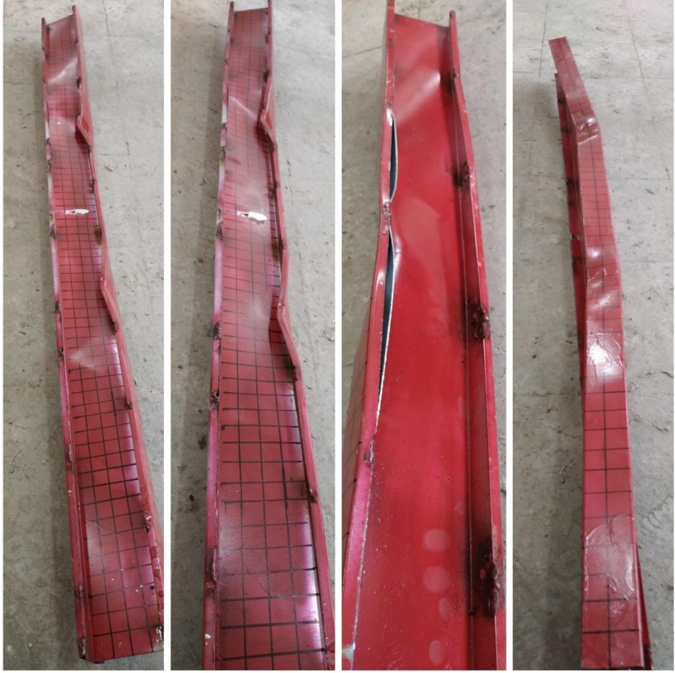
Şekil 5.4. I1 profilinde meydana gelen deformasyon
