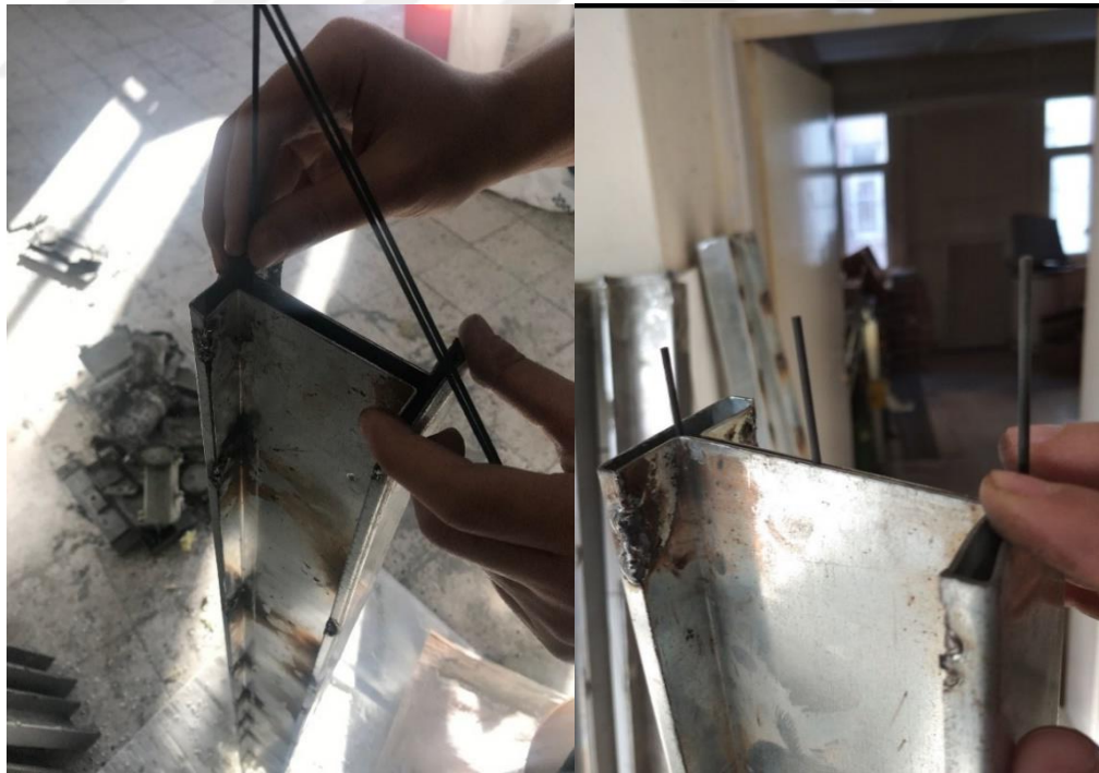
Şekil 5.11. I3 profiline karbon fiber çubukların yerleştirilmesi
