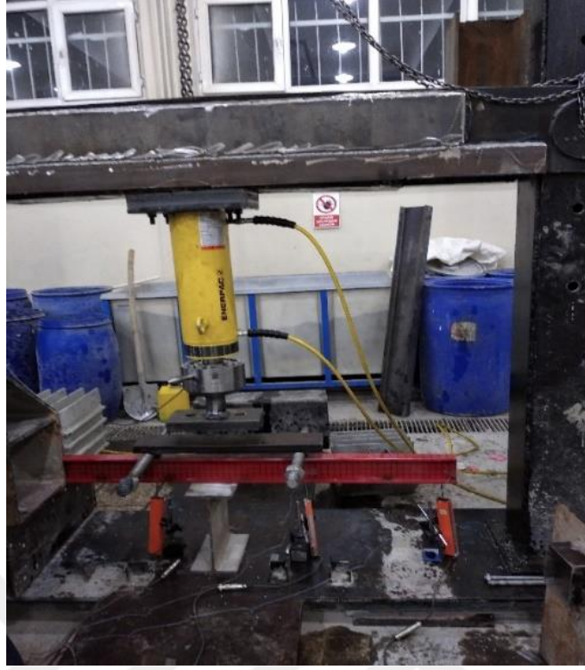
Şekil 5.25. I5 profilinin kesme deneyi için düzeneğe yerleştirilmesi
