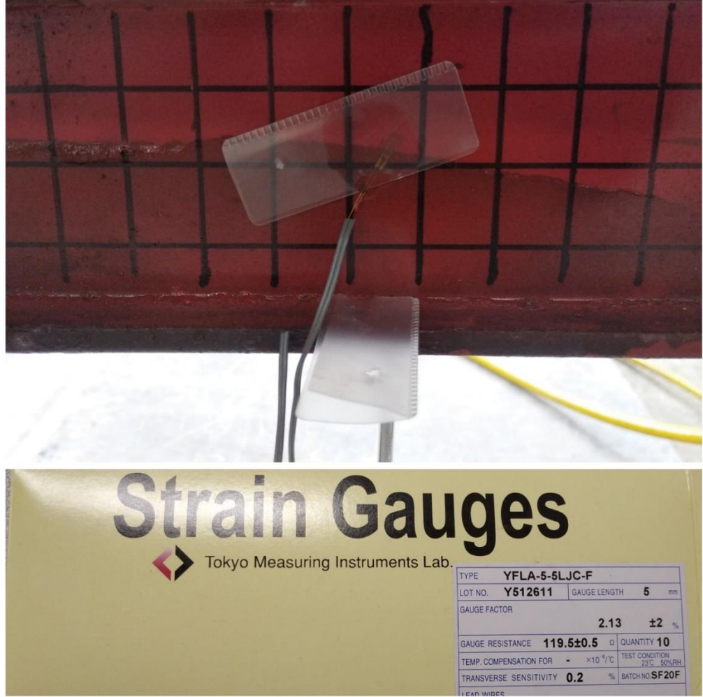
Şekil 4.15. Strain gaugelerin deney numunesine yerleştirilmesi
