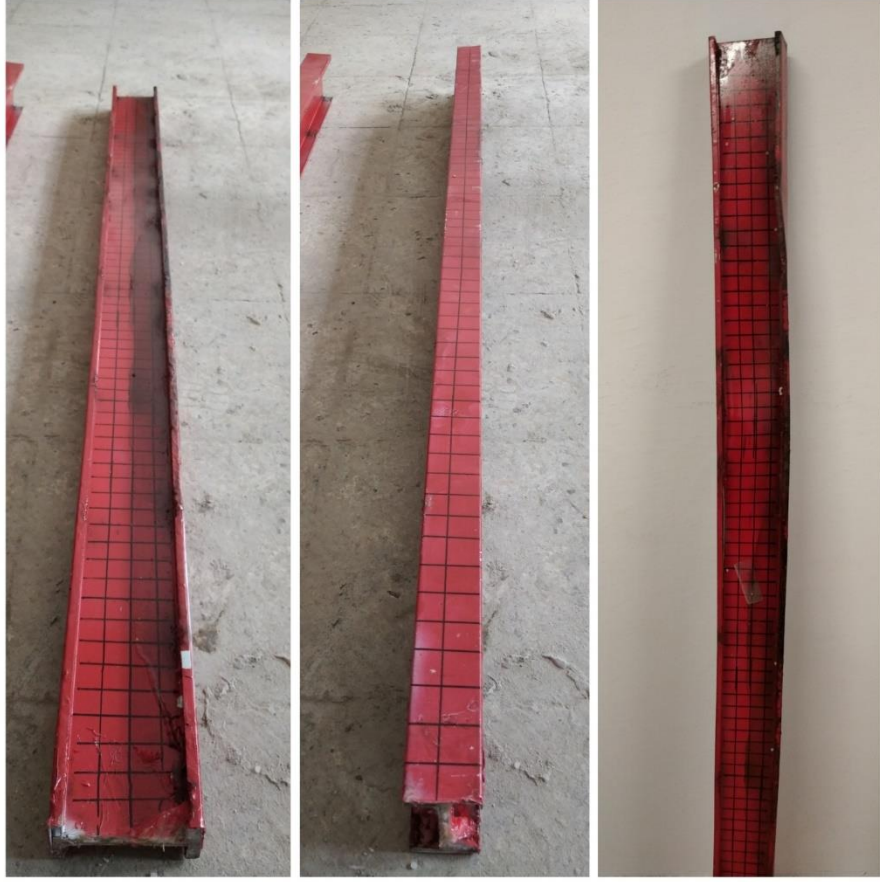
Şekil 5.14. I3 profilinin deneyden önceki ve sonraki hali
