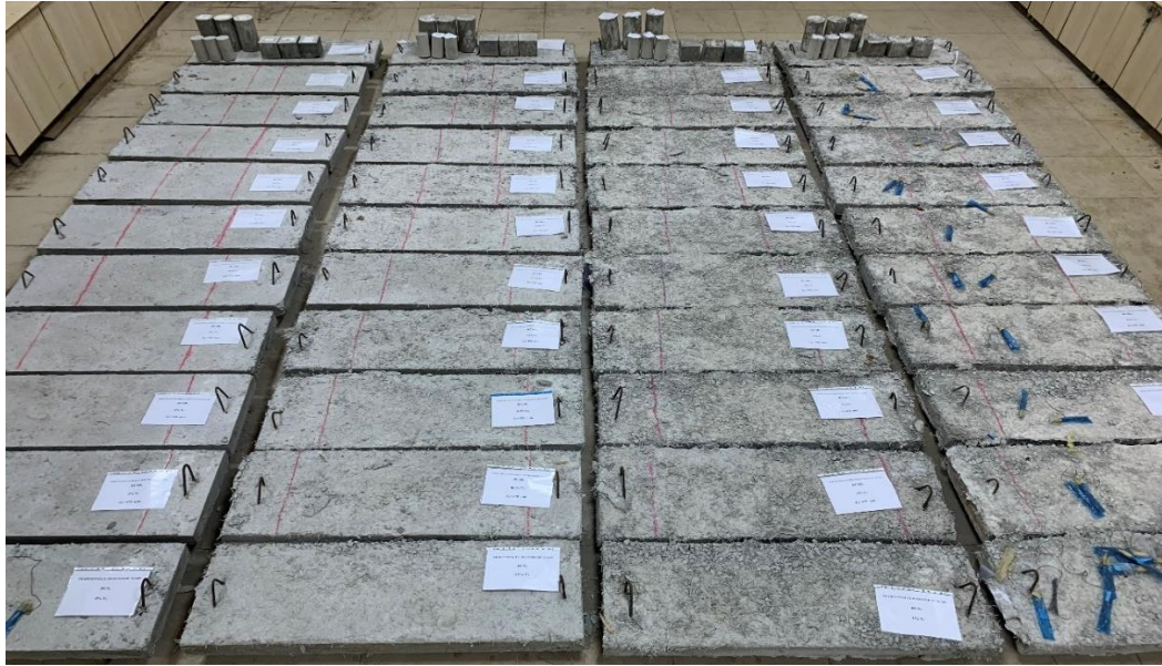
Şekil 4. 8. Deneyler için hazır hale getirilen betonarme döşemeleri.
