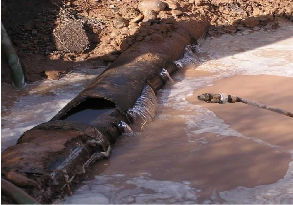
Şekil 2.6. Şebeke Yaşına Bağlı Olarak Çürüyen Boru
