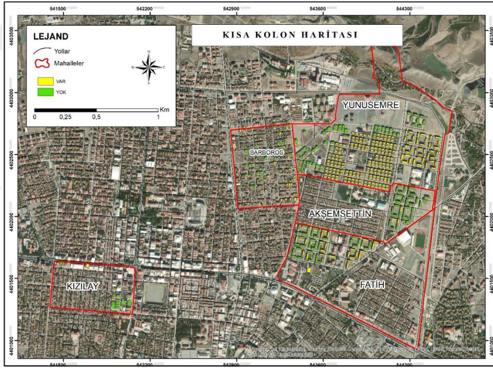
Şekil 5.87. Binaların kısa kolon etkisine göre haritalandırılması
