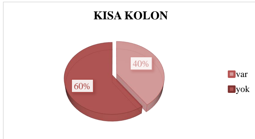
Şekil 5.52. İncelenen binaların kısa kolon dağılımları
