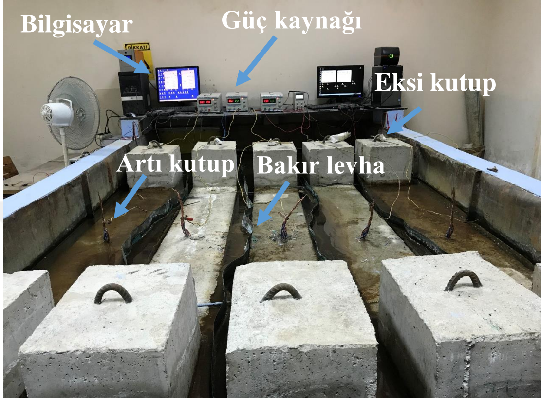
Şekil 4.7 Tam ölçekli paslandırma havuzunda numunelerin paslandırılması
