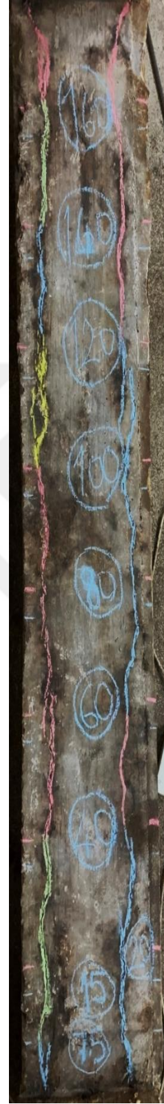
Şekil 5.13. C2 Betonarme kolonu için çatlak deseni
