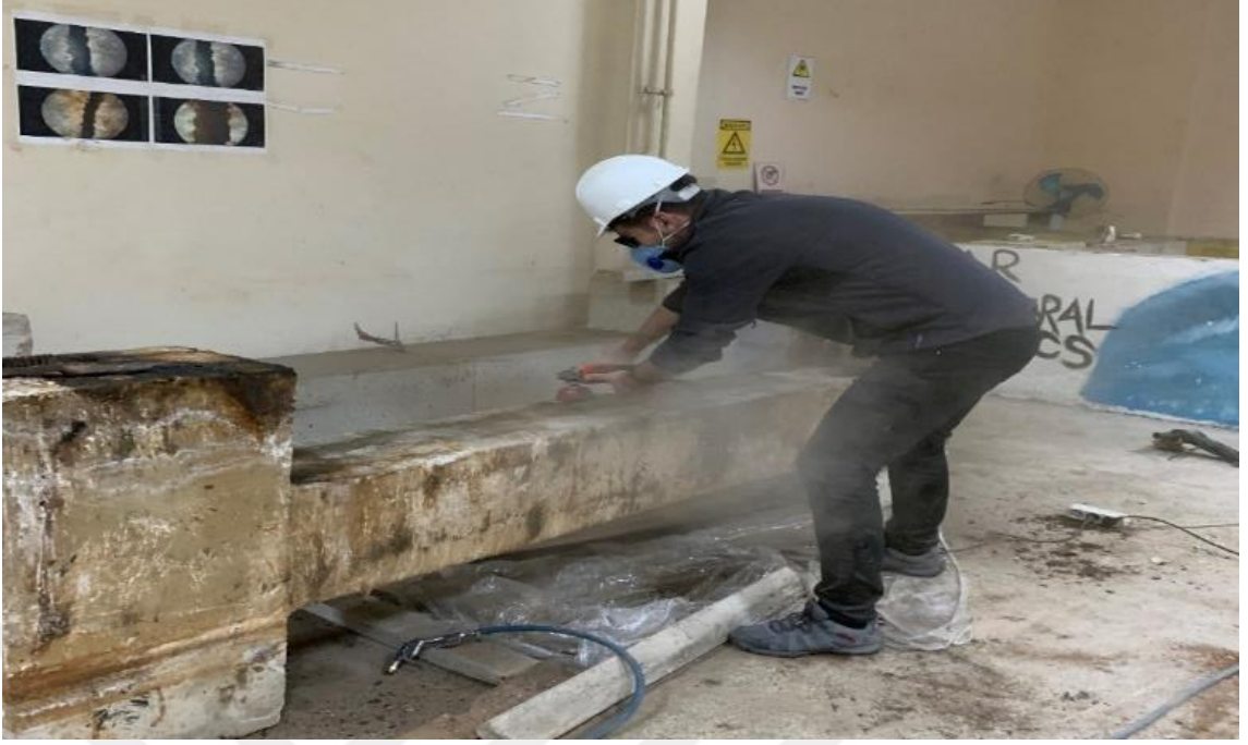
Şekil 5.11. Paslandırma sürecinden sonra numunelerin temizliği
