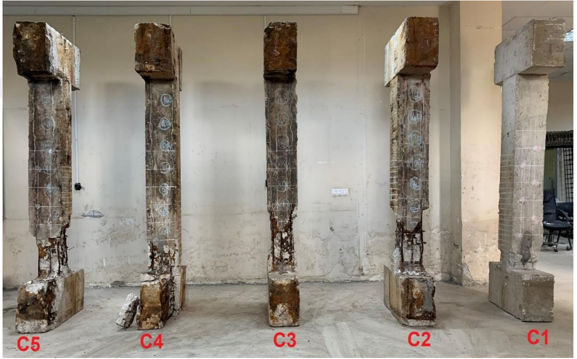
Şekil 5.1 Yükleme deneylerinden sonra kolon numuneleri
