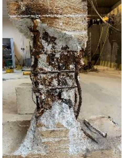
Şekil Ek-1.2 C2 numunesinin deney sonrası görüntüleri
