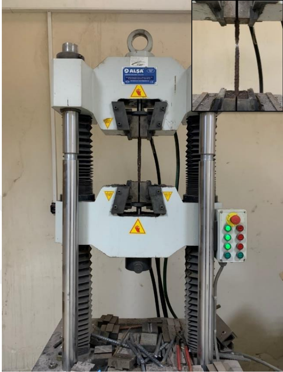
Şekil 5.9. Paslanmış betonarme donatıları için çekme deneyi
