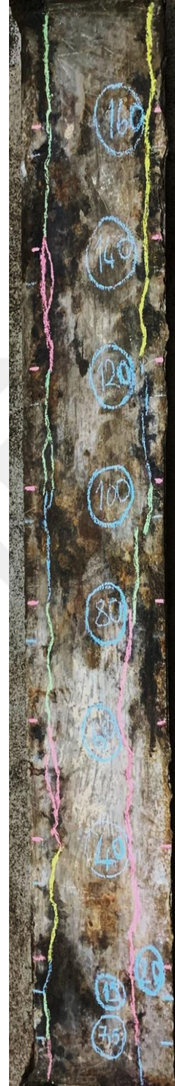
Şekil 5.15. C4 Betonarme kolonu için çatlak deseni
