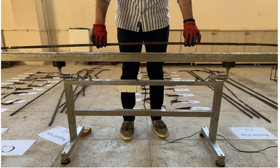
Şekil 5.5. Donatıların hassas terazi ile son ağırlıklarının tartımı
