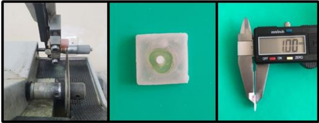
Resim 3. 3: Numunelerin Minitom Cihazıyla Kesilmesi ve 1 mm'lik Dentin Dilimlerinin Elde Edilmesi
