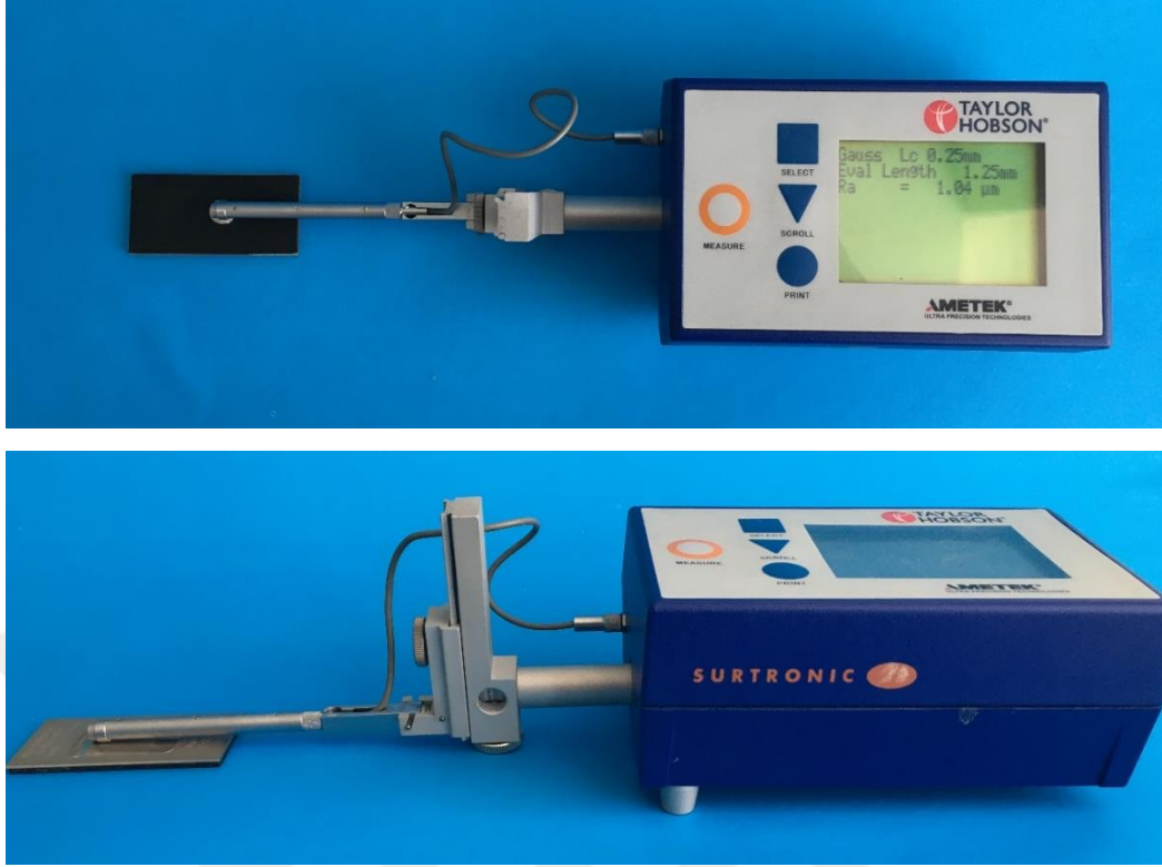
Resim 3.12. Yüzey pürüzlülüğü ölçüm cihazı (Surtronic 25)
