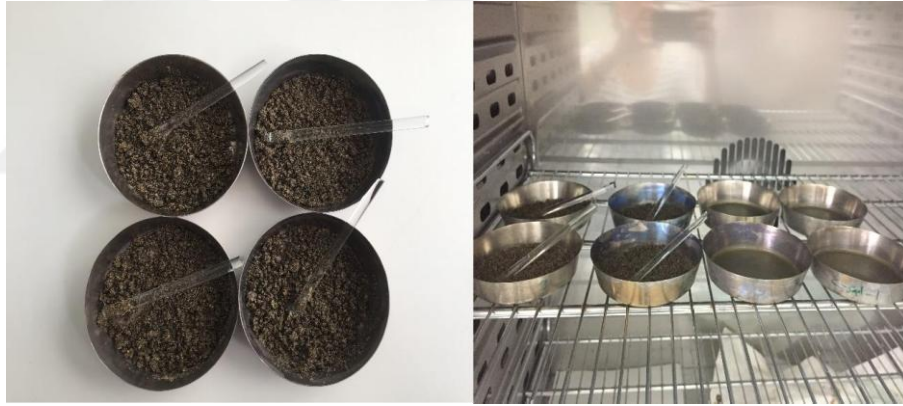
Şekil 3.3. Süt, peynir ve salamura örneklerinde kurumadde tayini (gravimetrik yöntem)
