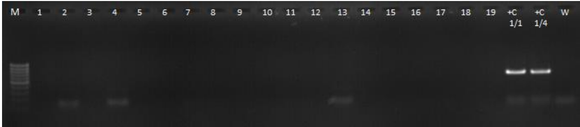
Şekil 4.14 Bursa' dan toplanan rubus örneklerinde blackberry yellow vein associated virüs tespiti için BYVaVF/R primer çifti kullanılarak yapılan RT-PCR analiz sonucu M: Marker (SMO#383 MBI Thermo Sci, ABD); 1-19: Bursa rubus örnekleri; W: Su kontrol; +C: Pozitif kontrol 1/1- doğrudan ve 1/4 seyreltme)
