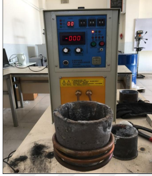
Şekil 3.2. Numunelerin ergitilmesinde kullanılan indüksiyon fırını ve silisyum karbür pota (Mersin Üniversitesi/ Mühendislik Fakültesi)
