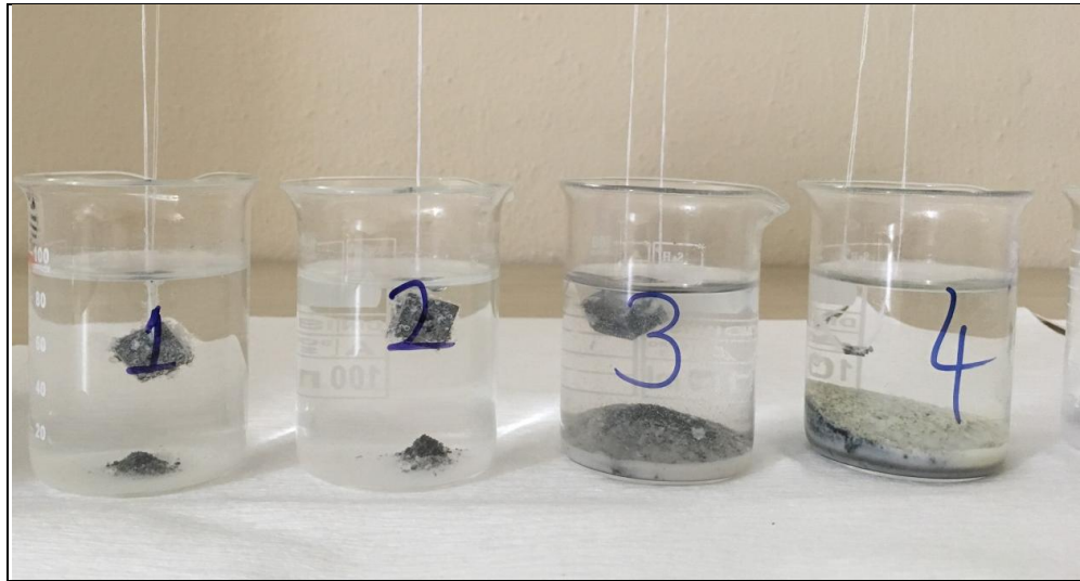
Şekil 4.54. Mg-4Sn (1), Mg-4Sn-1Ce (2), Mg-4Sn-2Ce (3) ve Mg-4Sn-4Ce (4) alaşımlarının HBSS içerisinde 7 günlük daldırma testi sonrası görüntüleri
