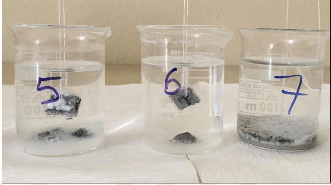
Şekil 4.59. Mg-4Sn-1La (5), Mg-4Sn-2La (6) ve Mg-4Sn-4La (7) alaşımlarının HBSS içerisinde 7 günlük daldırma testi sonrası görüntüleri
