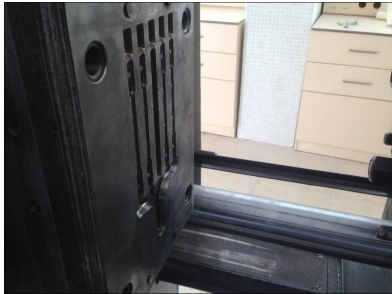
Şekil 3.4. Yüksek basınçlı döküm cihazında kullanılan metal kalıp (Mersin Üniversitesi/ Mühendislik Fakültesi)
