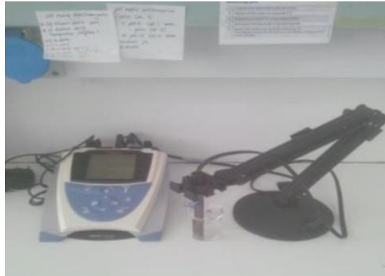
Şekil 3.8. pH-metre Orion, Thermo, Austin, TX, USA
