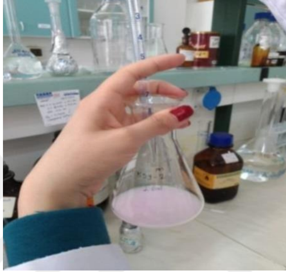
Şekil 3.7. Örneklere titrasyon asitliđi tayini
