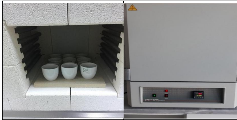
Şekil 3.6. Süt, peynir ve salamura örneklerinde kül tayini
