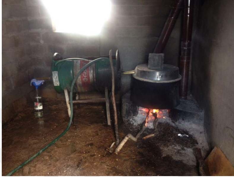
Şekil 1.1 Antakya’da kullanılan geleneksel rakı distile düzeni
