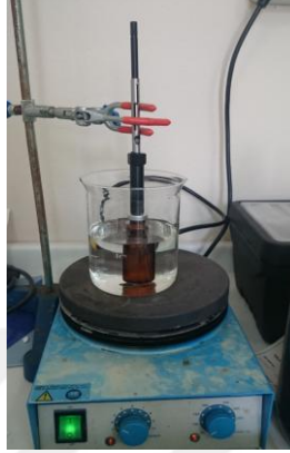
Şekil 3.1. Tepe boşluğu - katı faz mikro ekstraksiyon düzeneği (HS-SPME)
