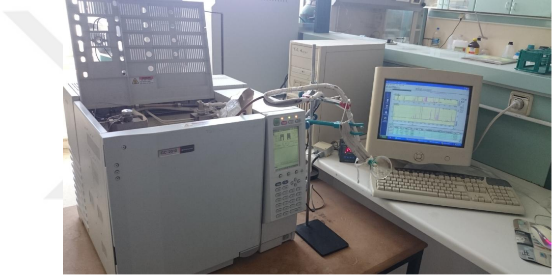
Şekil 3.2. Gaz kromatografisi-olfaktometri (Shimadzu GC2010, Japonya)
