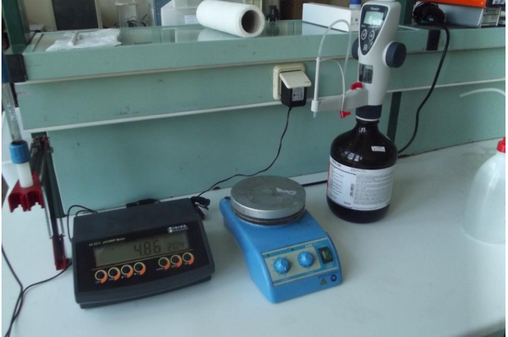
Şekil 3.12. 'Ortanique tangor' meyvelerinde elde edilen meyve sularında pH ve titre edilebilir asit miktarı ölçümü
