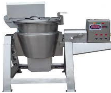
Şekil 1.2. Eritme Boru tipi Künefe peynirlerinin yapımında kullanılan peynir eritme kazanı.
