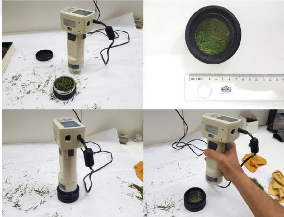
Şekil 3.14. Renk ölçer ile çim yaprağı renk değeri ölçümü
