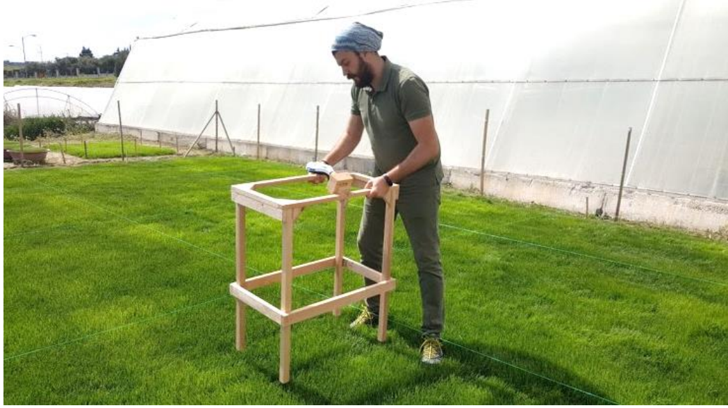
Şekil 3.17. Kampüs çim deneme alanında el tipi algılayıcı ile NDVI ölçümü
