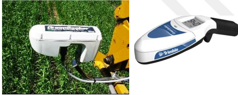
Şekil 1.8. Tarla bitkilerinde azot konsantrasyonu tespitinde kullanılan el tipi (sağda) ve araç üzerine takılan (solda) GreenSeeker sistemi (Trimble, 2010)
