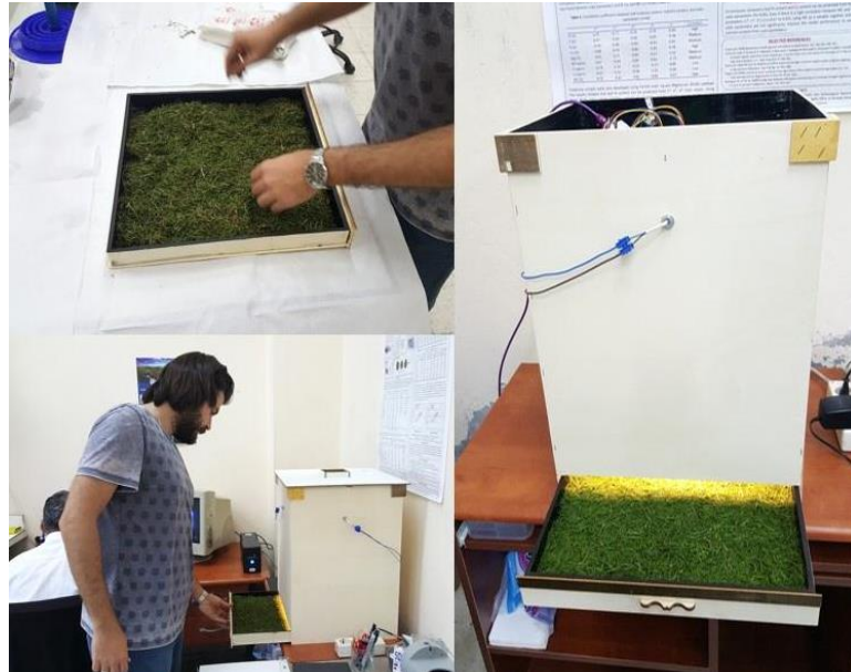
Şekil 3.13. Prototip optik algılayıcı ile yansıma ölçümü
