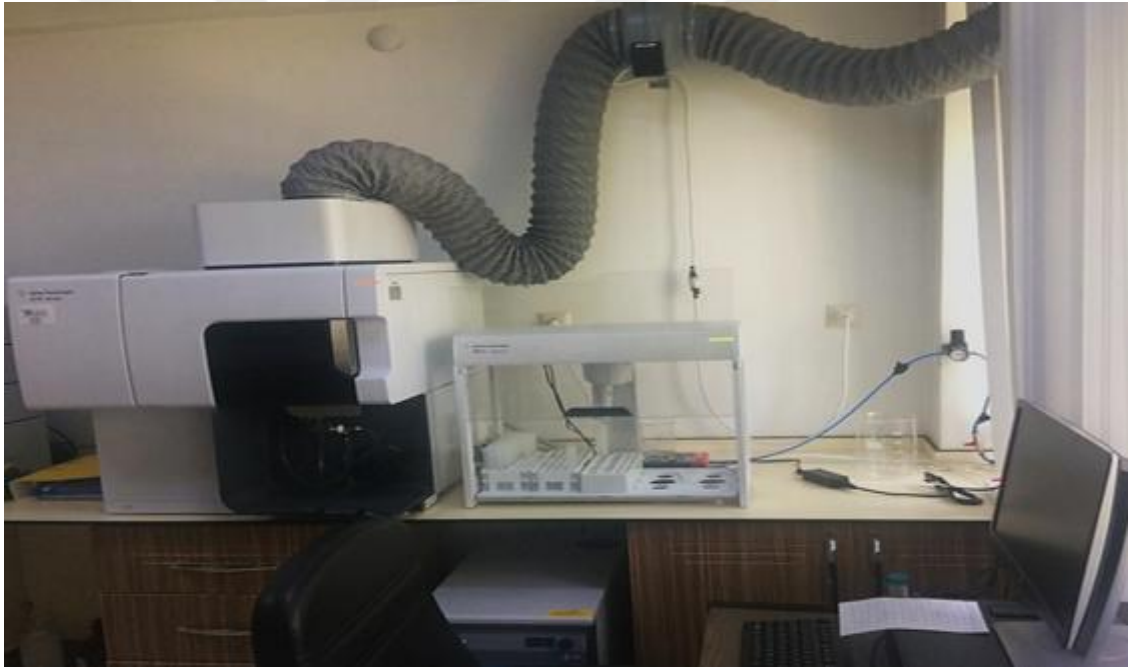
Şekil 3. 6. Denemede kullanılan ICP-OES (İndüktif Eşleşmiş Plazma Optik Emisyon Spektrometresi)
