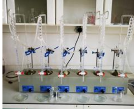
Şekil 3.13. Clevenger aparatı ve uçucu yağ düzeneğinden bir görüntü
