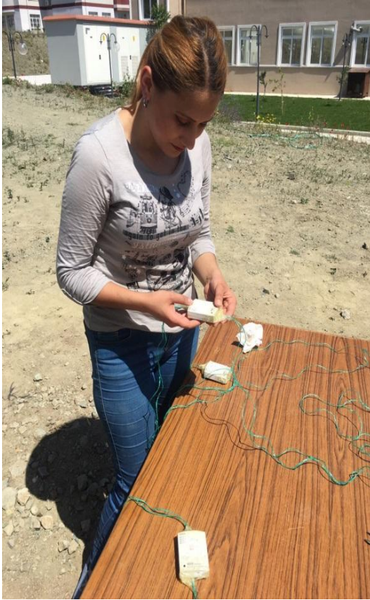
Şekil 3.11 Sıcaklık ve nem kaydedicilerin konumlandırılması
