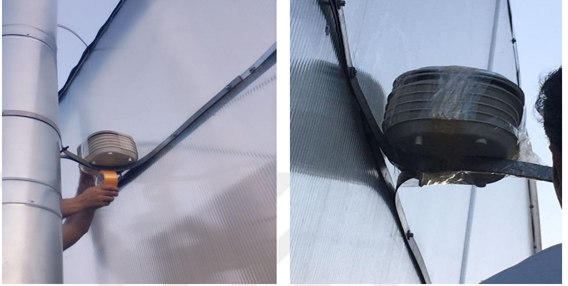
Şekil 3.9 Sera dışına kurulan dış ortam sıcaklık kaydedici
