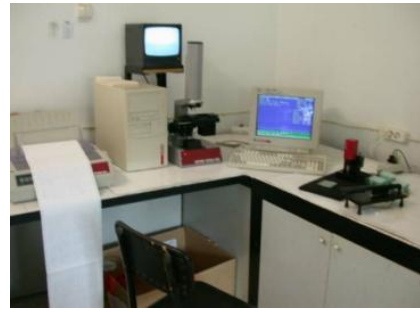
Resim 2.3. Elyaf İncelik Analizinde Kullanılan “USTER OFDA 100 Instrument for Measuring Wool Diameter” Cihazı.
