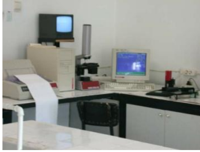
Resim 2.3. Elyaf İncelik Analizinde Kullanılan “USTER OFDA 100 Instrument for Measuring Wool Diameter” Cihazı.
