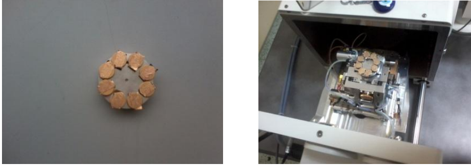
Resim 2.7. SEM-EDX Analizi için Altınla Kaplanmış Yapağı Örnekleri
