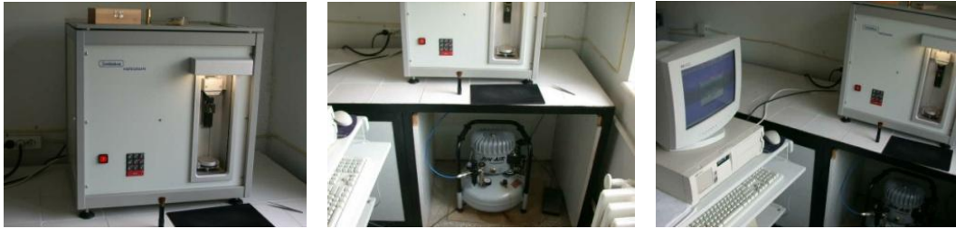
Resim 2.5. Elastikiyet ve Mukavemet Analizinde Kullanılan “Single Fibre Tensile Tester FAFEGRAPH HR + ME” Cihazı.
