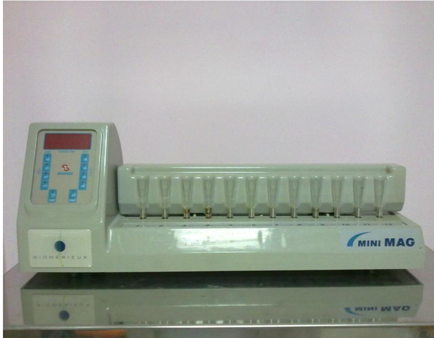
Resim 2: NucliSENS® Mini MAG manyetik DNA izolasyon cihazı.
