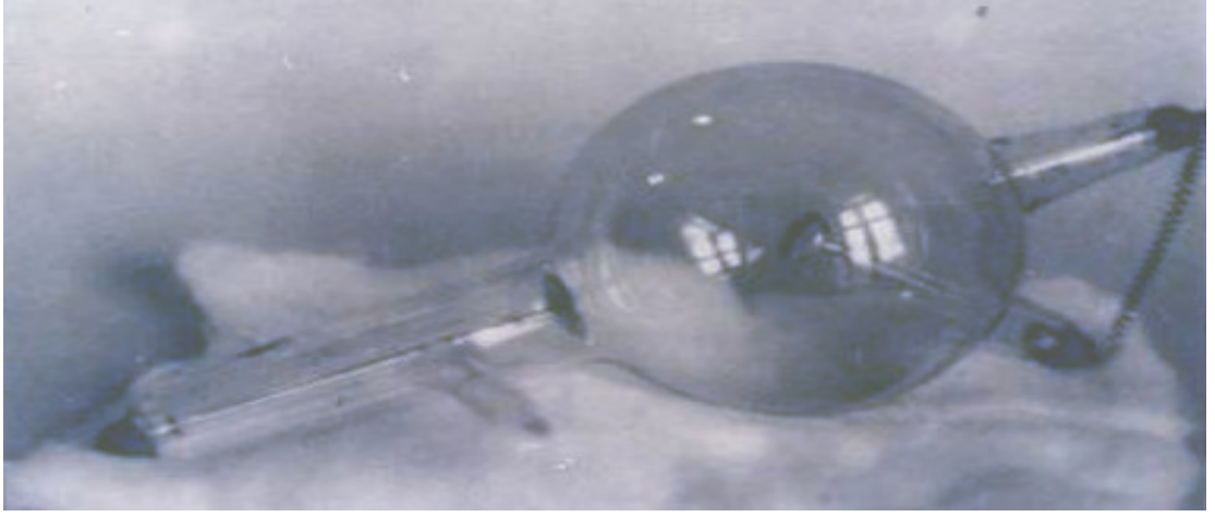
Resim 1.2. Dr. Esat Fevzi ve Dr. Rifat Osman tarafından kullanılan Crookes katot ışın tüpünün bir eşi(40).
