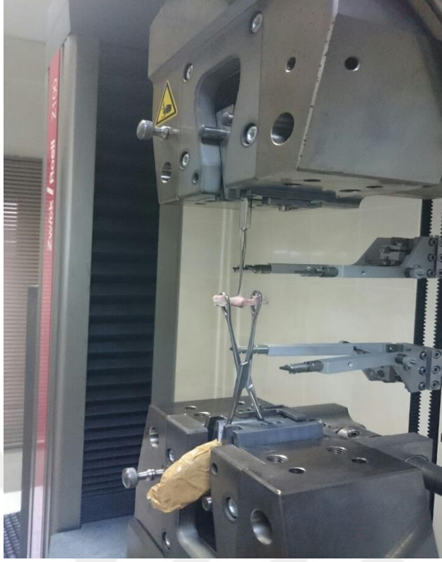
Resim 13. Çekme makinesine aparatların ve kemiklerin yerleştirilmesi
