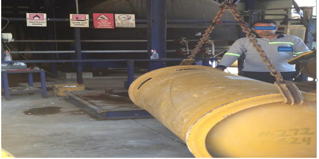
Şekil 6. Ana Üretim Tesisinde Klor Tankı Yerleştiren Bir Operatör
