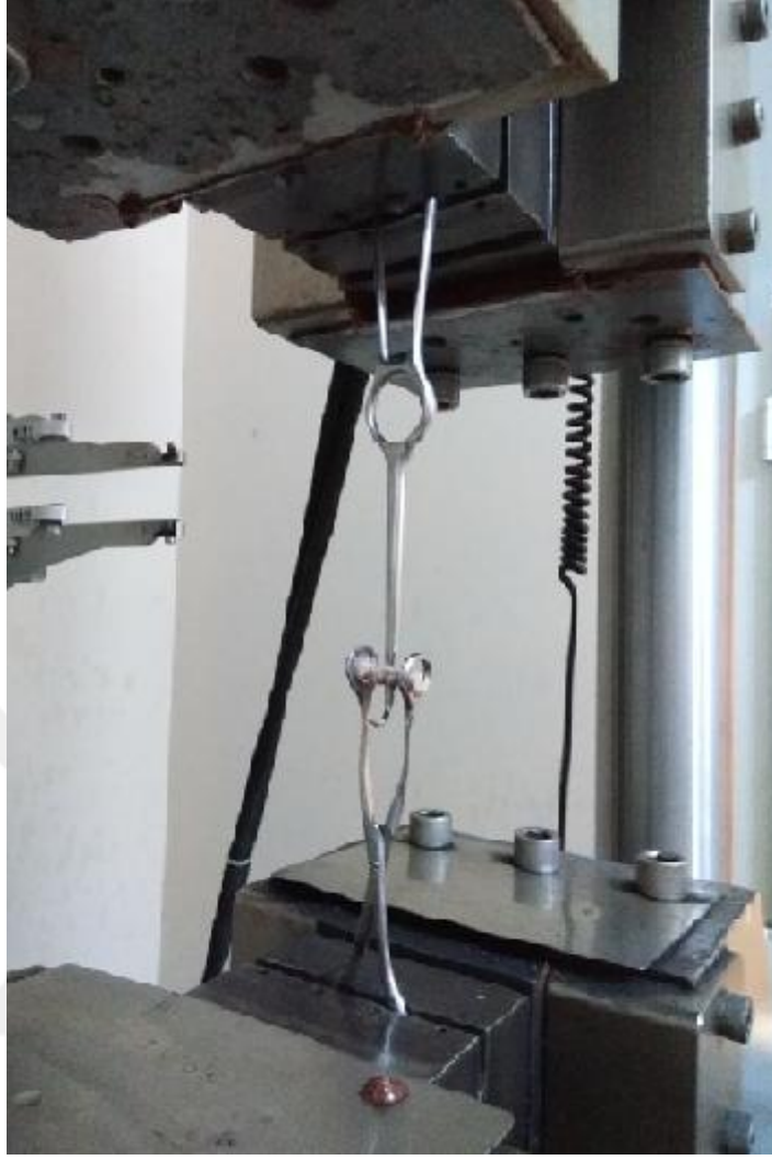
Resim 13. Çekme makinesine aparatların ve kemiklerin yerleştirilmesi
