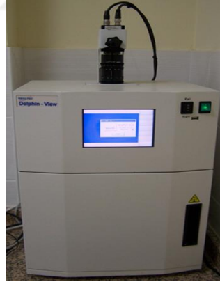
Resim 3. Jel elektroforez sonrası PCR ürünleri görüntüleme cihazı (Wealtec Dolphin-View, ABD, UV Transillumunator)
