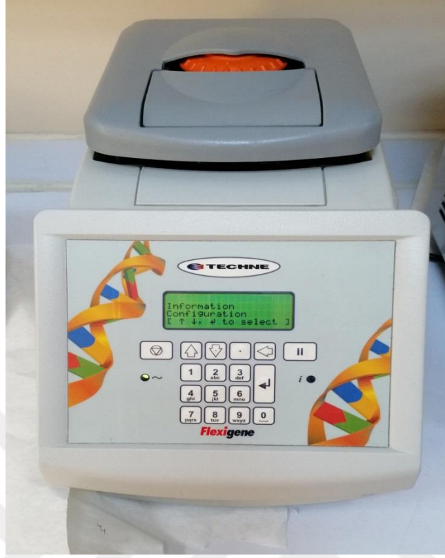
Resim 1. PCR Cihazı (Thermal cycler, Techne FlexigeneTM, İngiltere)
