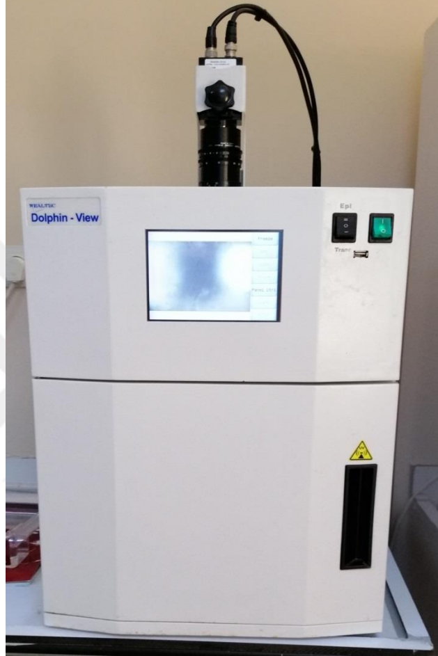
Resim 4. Jel elektroforez sonrası PCR ürünleri görüntüleme cihazı (Wealtec Dolphin-View, ABD, UV Transilluminator)
