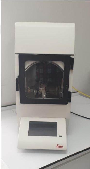
Şekil 3.10. SEM öncesi materyal kaplama cihazı
