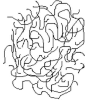
Şekil 1.4 Yarı-Kristal ve Amorf polimer zincir yapısı
