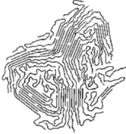
Şekil 1.4 Yarı-Kristal ve Amorf polimer zincir yapısı
