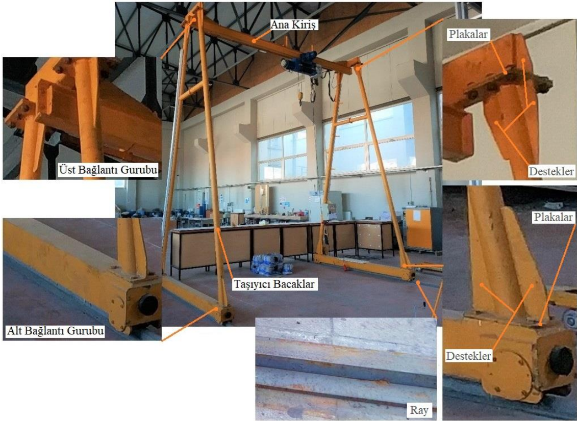
Şekil 3.1 Laboratuvar içerisindeki portal kren.
