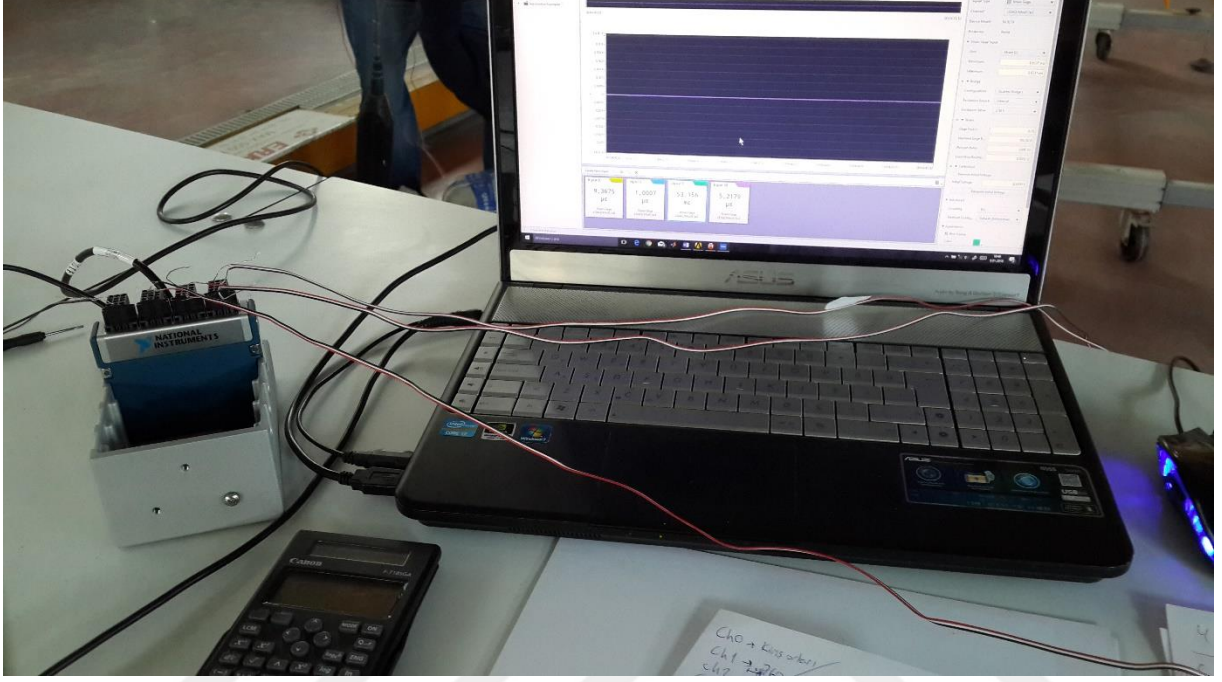
Şekil 6.2 NI CDAQ-9174 ve NI DaQ Express programı.
