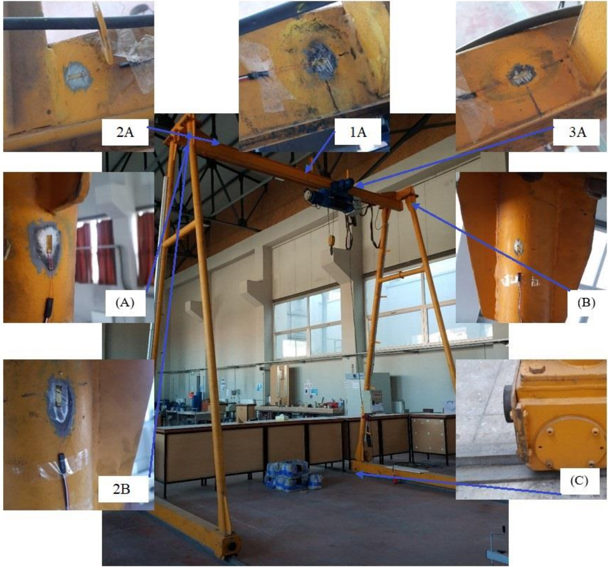
Şekil 6.1 Gerilimölçer uygulanan noktalar.
