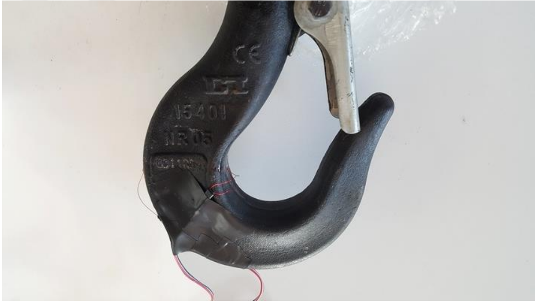
Şekil 6.6 SGS1 ve SGS2 strain gage sensörleri yapıştırılmış kanca.
