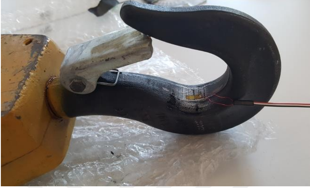
Şekil 6.7 Strain gage sensörü (SGS1) yapıştırılmış kanca.
