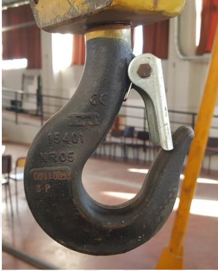
Şekil 6.2 DIN 15401 05 numaralı kancaya sensörler takılmadan önceki durumu.
