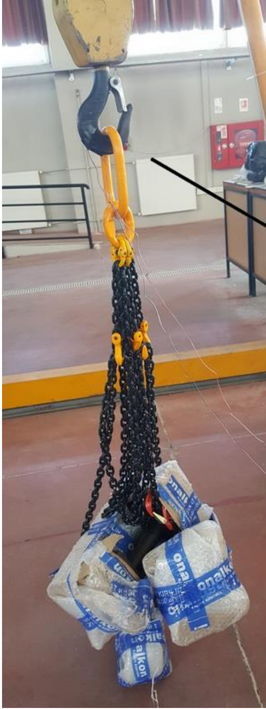
Şekil 6.10 a) Ağırlıkların strain gagelerin yapıştırıldığı kancaya asılması, b) Ağırlıklar asılı kancanın detay görünümü.
