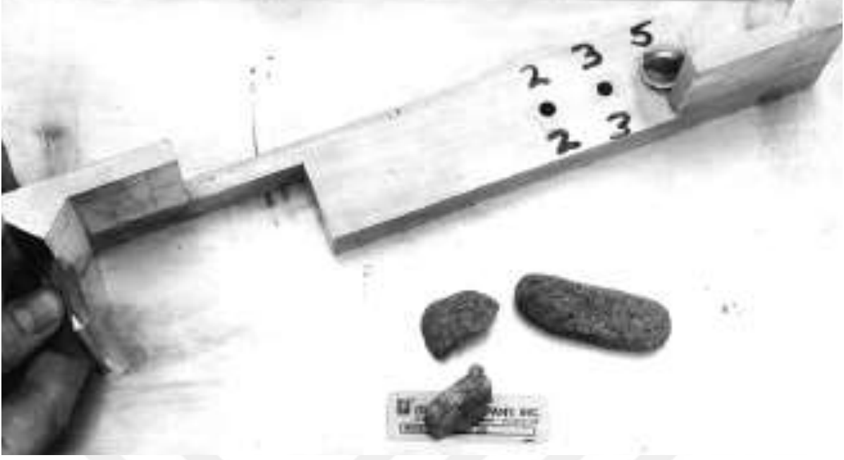
Şekil 2.3 Agrega ölçümünde kullanılan orantılı kumpas (Tutumluer et al. 2005).
