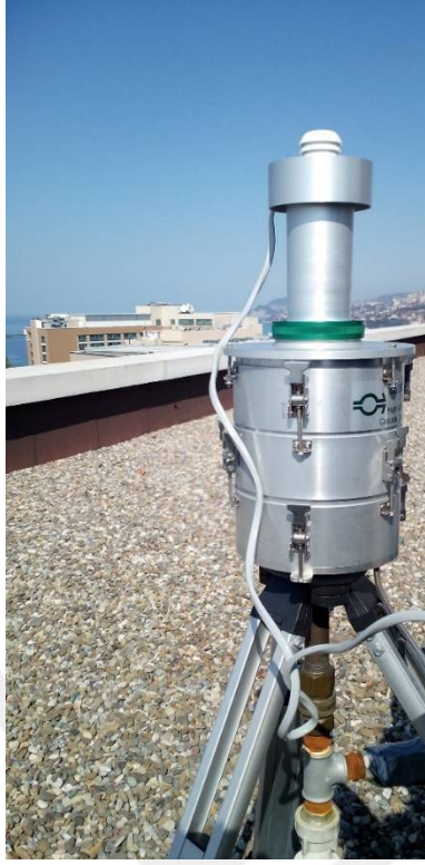
Şekil 2.18 Aerobioloji gözlem istasyonunda Yüksek Hava Örnekleyicisinin kalibre edilmesi.
