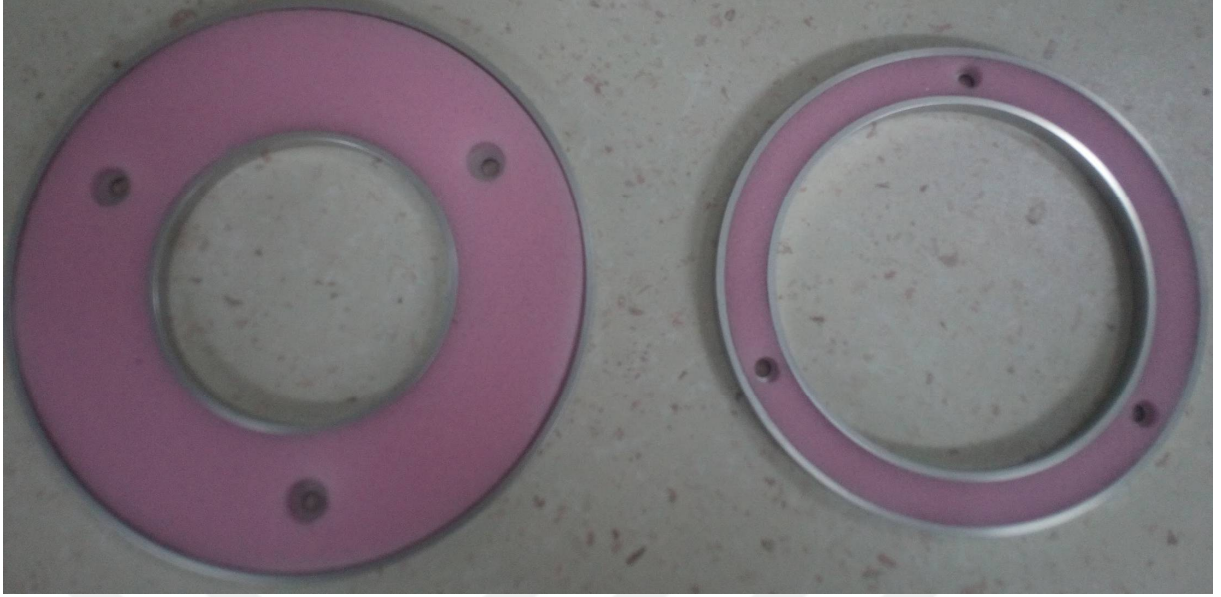
Şekil 2.8 Soldan sağa doğru alerjenlerin toplanmasında kullanılan PM>10 ve 10>PM>2.5 poliüretan filtreler.
