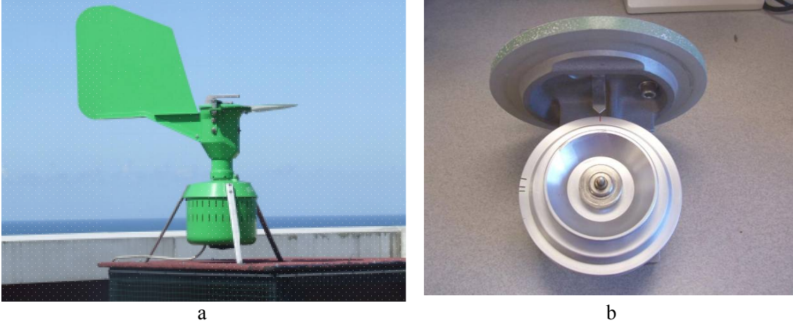
Şekil 2.4 a. Burkard Cihazının genel görüntüsü, b. Burkard cihazının içerisinde yer alan ve şeffaf bandın sarıldığı döner disk.
