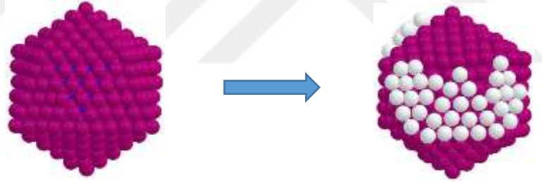
Şekil 4.33 Ni 147 Ag 414 Nanoalaşımının T=370 K sıcaklığındaki yapısal değişim
