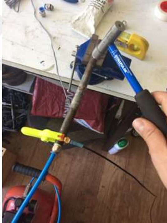
Şekil 2.5 Deney düzeneğinde darbe çekici ile uygulama
