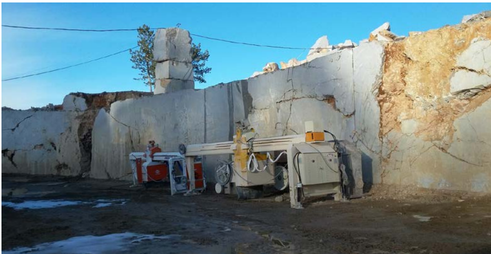
Şekil 3.2 Sarnıçköy gülkan madencilik ocağında kullanılan köprülü kesme makinası.
