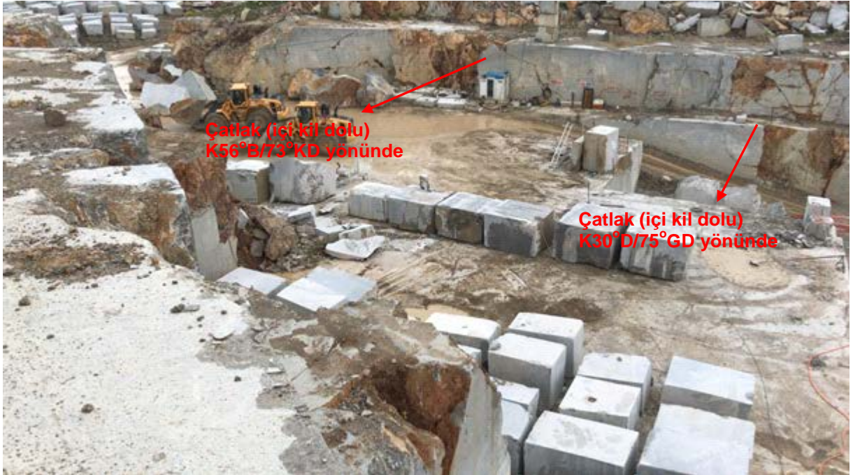
Şekil 6.2 Azdavay Sarnıçköy sahasındaki çatlakların yönü (2).
