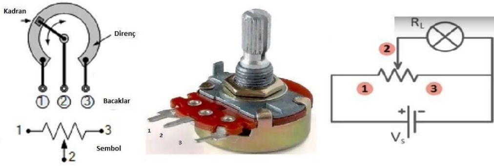
Şekil 1.8 Potansiyometre görünümü ve iç yapısı.
