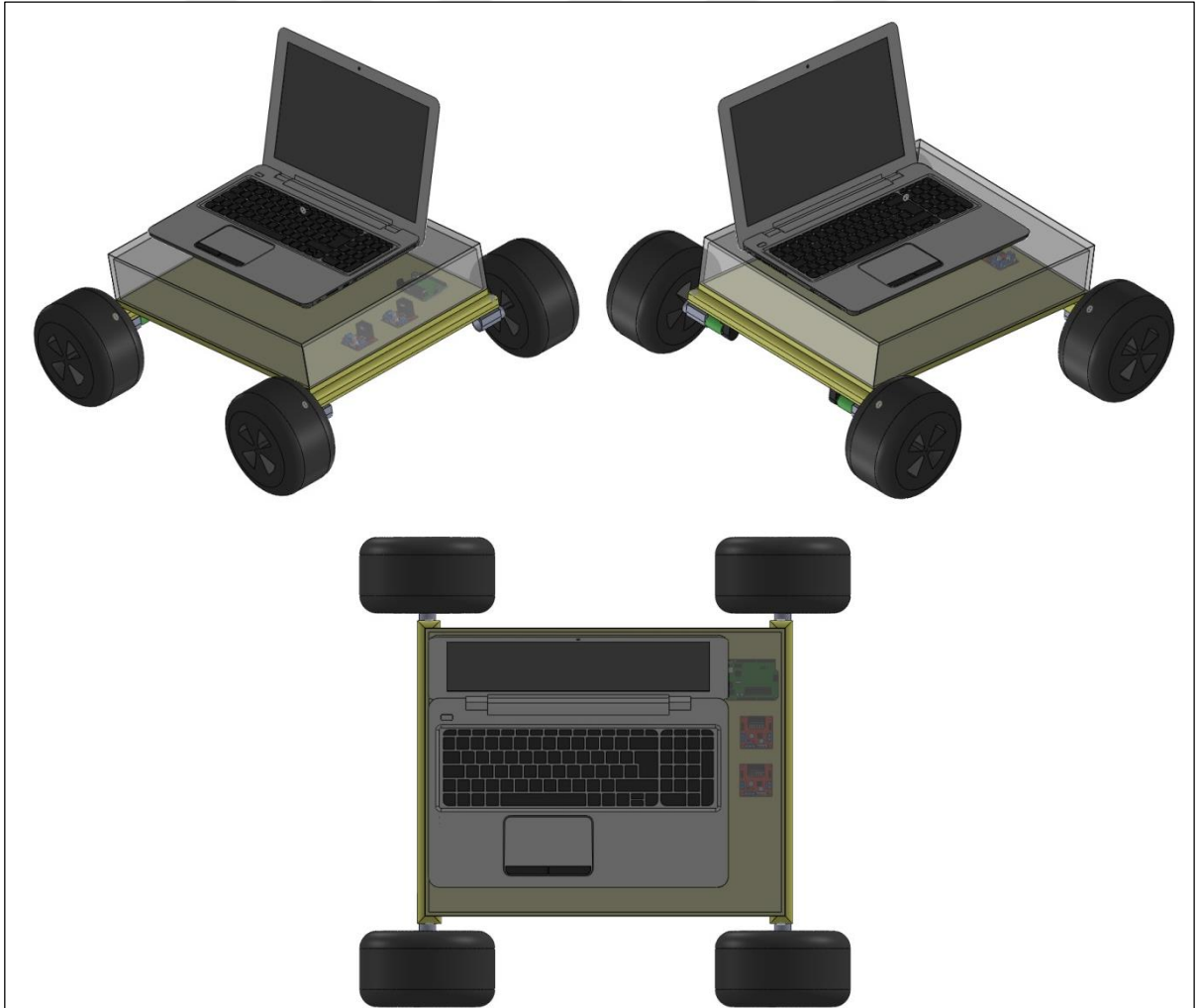
Şekil 5.1 Mobil robotun katı model tasarımı.
