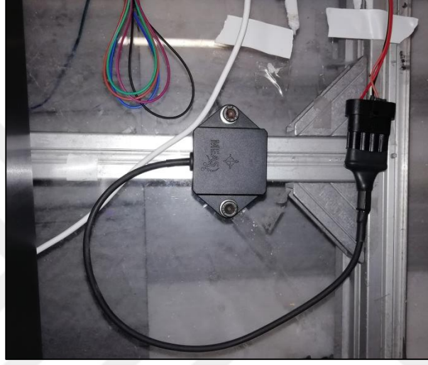
Şekil 5.5 DOG2 eğim sensörü.
