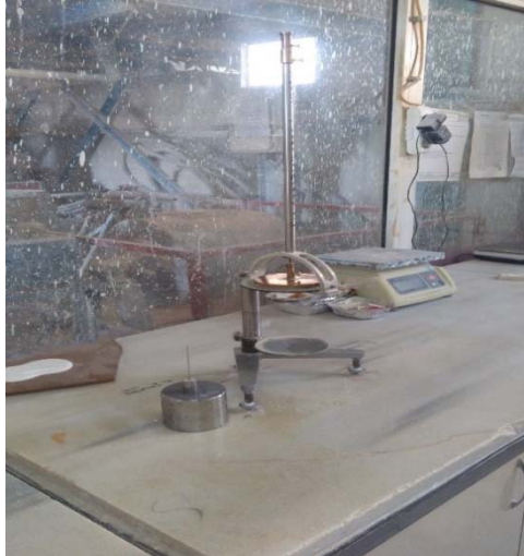
Şekil 4.9 Payne marka gallencump ve piknometre.
