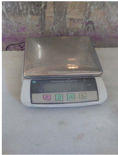
Şekil 4.7 NS-3200 g marka 0,1 gr hassasiyetli terazi.
