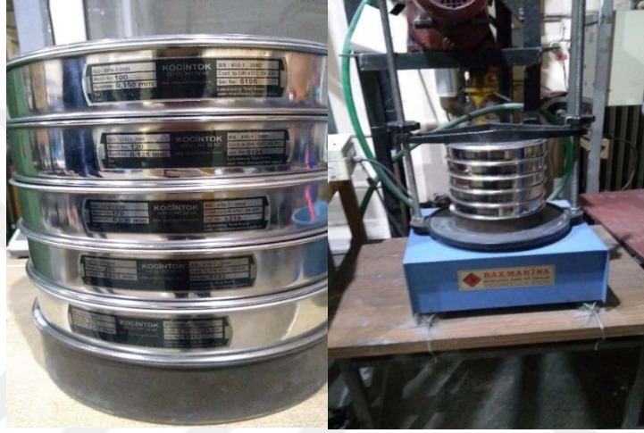
Şekil 4.3 Elek analizinde kullanılan elek takımı ve sarsma makinesi.
