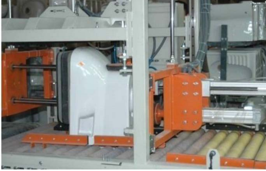
Şekil 2.17 Klozet fonksiyon test makinesi (URL-5).
