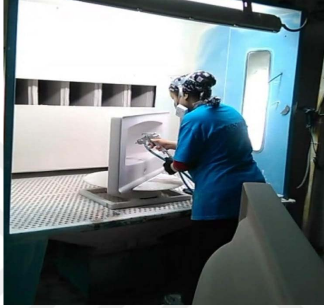
Şekil 2.14 Manuel olarak yapılan sırlama işlemi.
