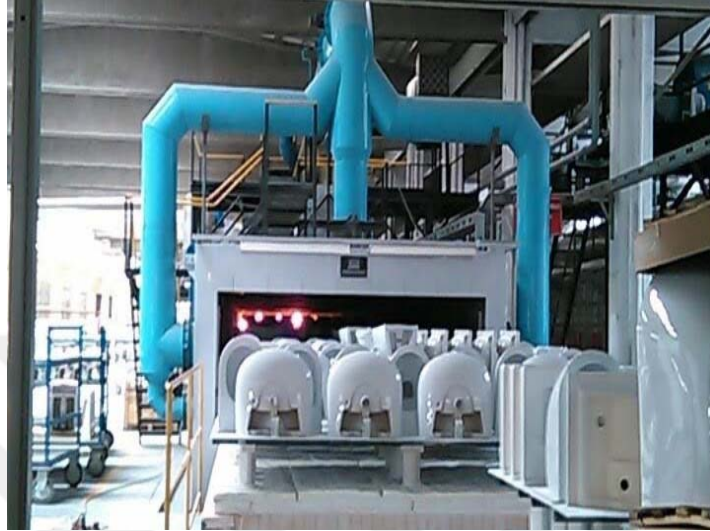
Şekil 2.15 Sırlanan numunelerin pişirilmesi.
