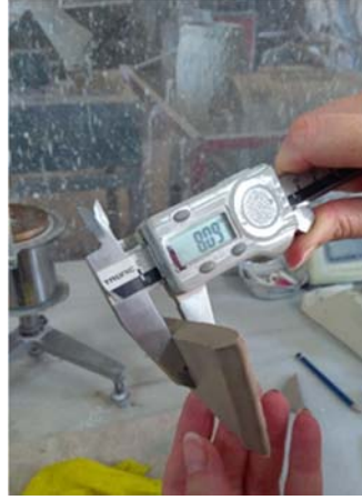
Şekil 4.12 Plakaların kuru küçülme değerlerinin ölçülmesi.
