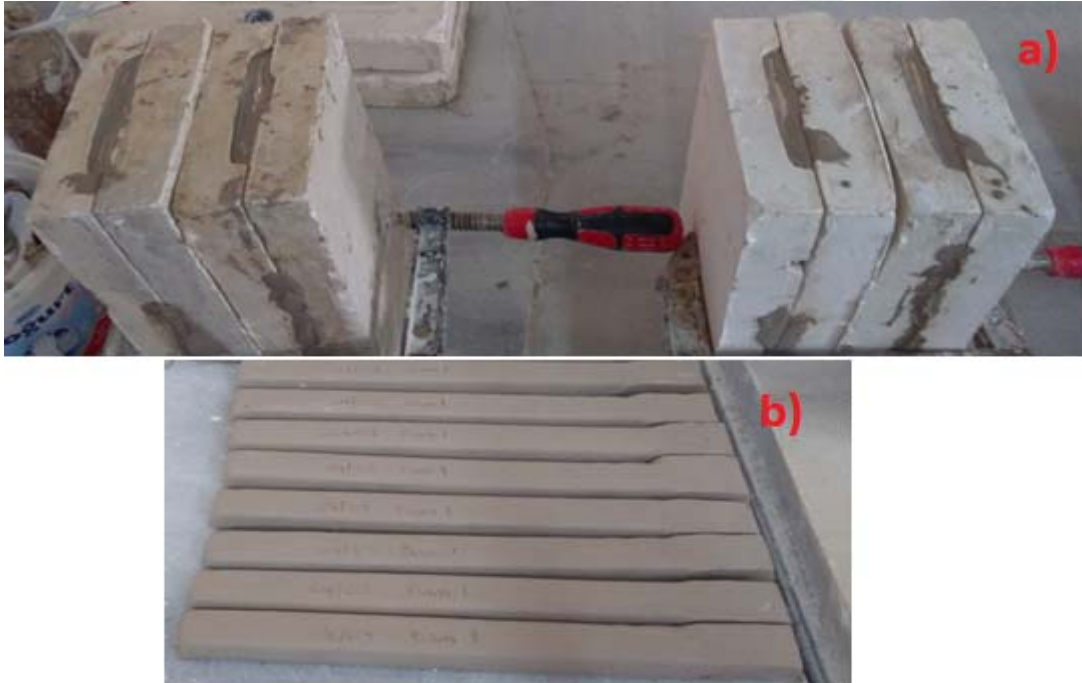
Şekil 4.13 Dökümü yapılan deformasyon çubukları.
