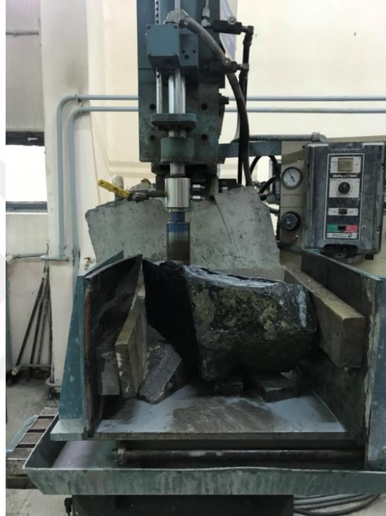
Şekil 4.14 NX tip karotiyer kullanarak kaya bloklarından silindirik numune alma işlemi.
