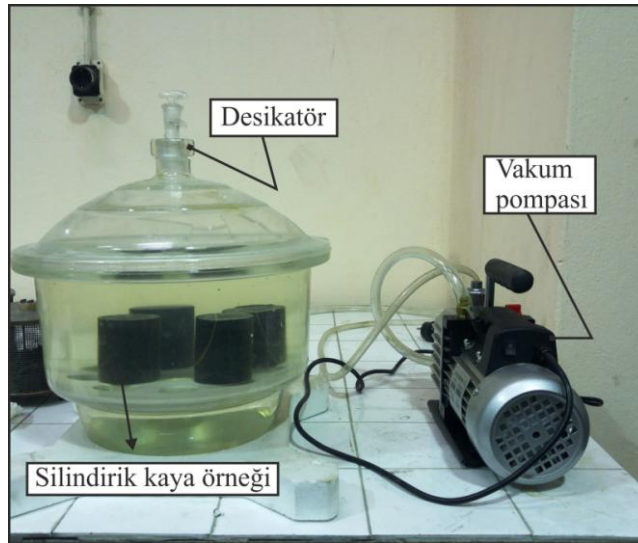
Şekil 4.16 Kaya malzemesinin doymun hale getirilmesi.
