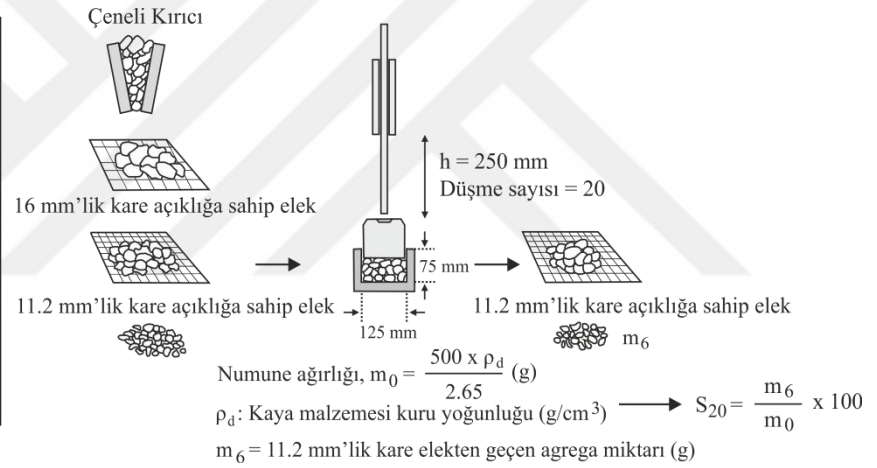
Şekil 4.38 S 20 kırılma indeksi deneyi metodolojisi (Dahl vd. 2012'den düzenlenerek).
