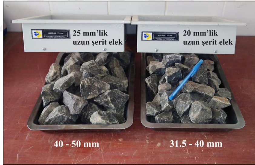
Şekil 4.35 W_0 tip balast agregalarında gerçekleştirilen bir yassılık indeksi deneyi.
