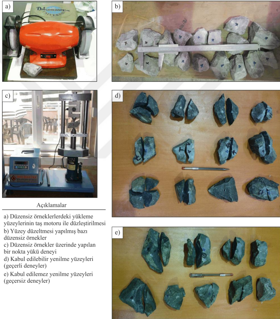
Şekil 4.21 Düzensiz örneklerde aksenal nokta yükü deneyleri (Köken ve Özarslan 2016).
