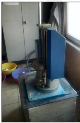
Şekil 4.38 S 20 kırılma indeksi deneyi metodolojisi (Dahl vd. 2012'den düzenlenerek).
