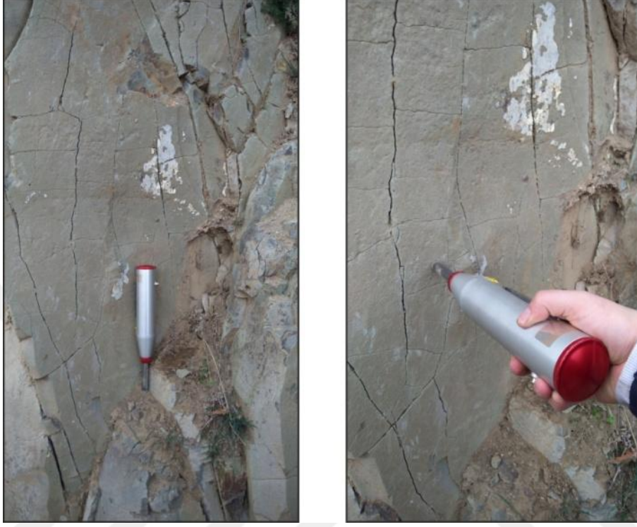
Şekil 4.7 Orta derecede ayrılmış bir bazaltik kaya kütlelerinde ( W_2 tip) gerçekleştirilen Schmidt çekici deneyleri.
