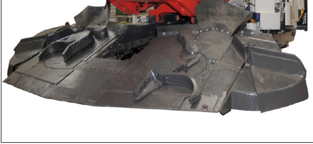
Şekil 3.13 Yengeç kolları yüklemesi (Sandvik 2014).
