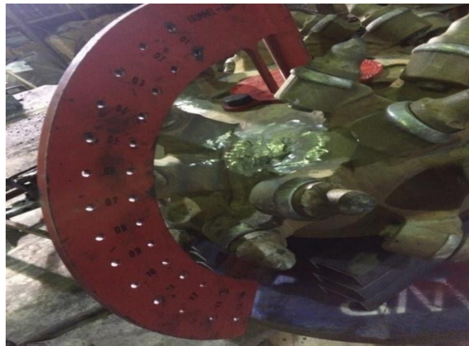
Şekil 8.18 DH R60T kesici uç tutucu açısının ve helis numarasının ayarlanması.
