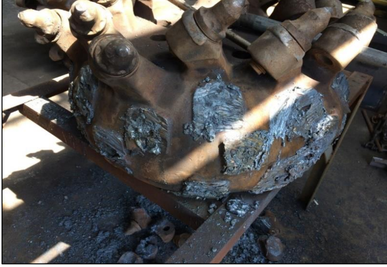
Şekil 8.15 Kırılan ve aşınan kesici uç tutucuların oksijen ile kesilmesi.
