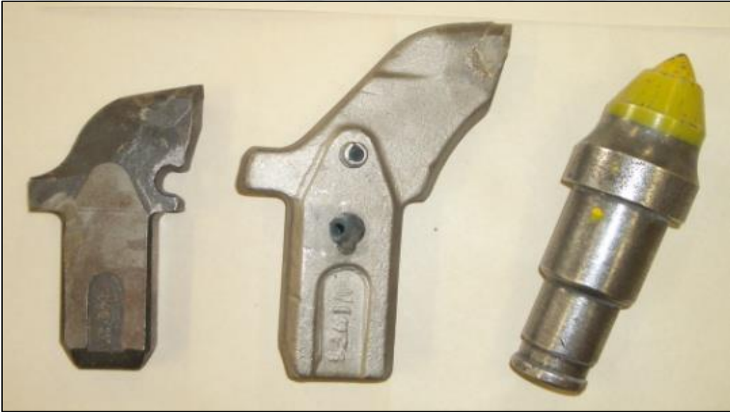
Şekil 3.6 Radyal, ileri atımlı ve konik keski (Doğrugöz ve Bölükbaşı 2012).
