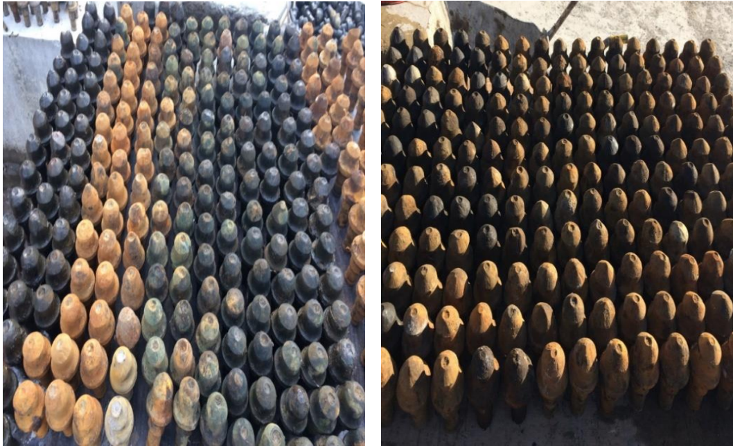
Şekil 8.13 Sunrise kesici uçlar aşınma şekilleri.
