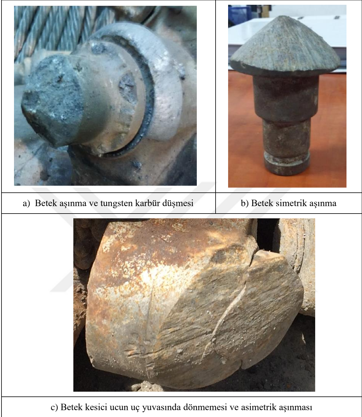
Şekil 6.20 Betek kesici uç aşınma şekilleri.
