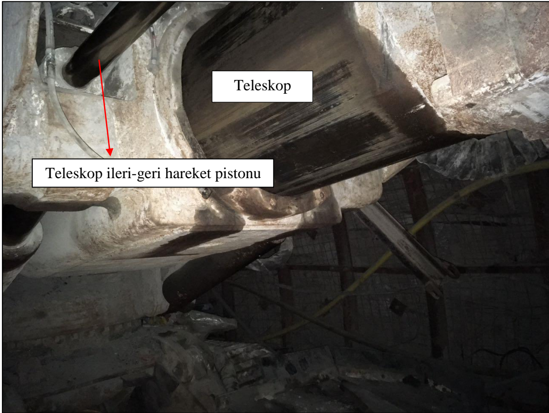
Şekil 3.5 Kesici kafa teleskobu.
