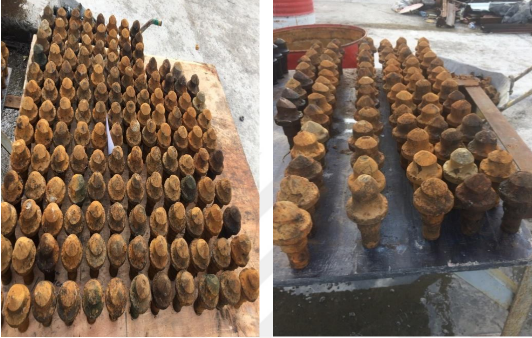
Şekil 8.12 Betek kesici uçlar aşınma şekilleri.
