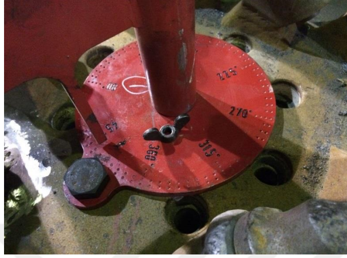
Şekil 8.17 DH R60T kesici kafa şablonu konumunun ayarlanması.
