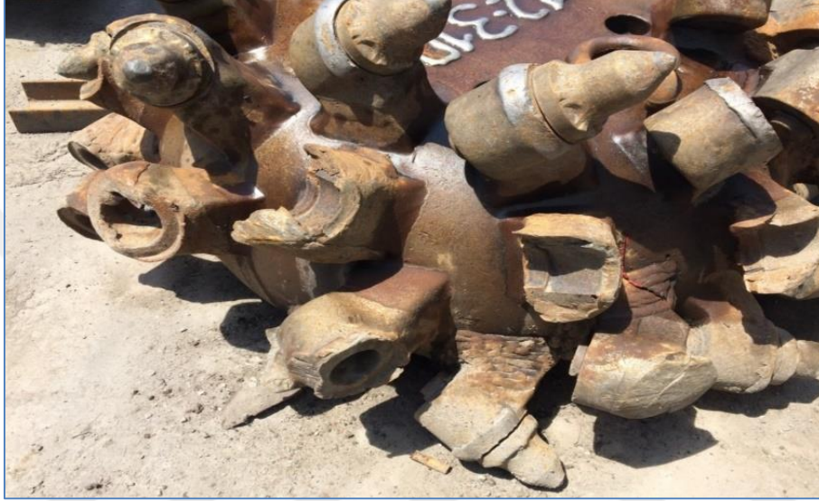
Şekil 8.14 DH R60T kesici kafada kırılan kesici uç tutucular.
