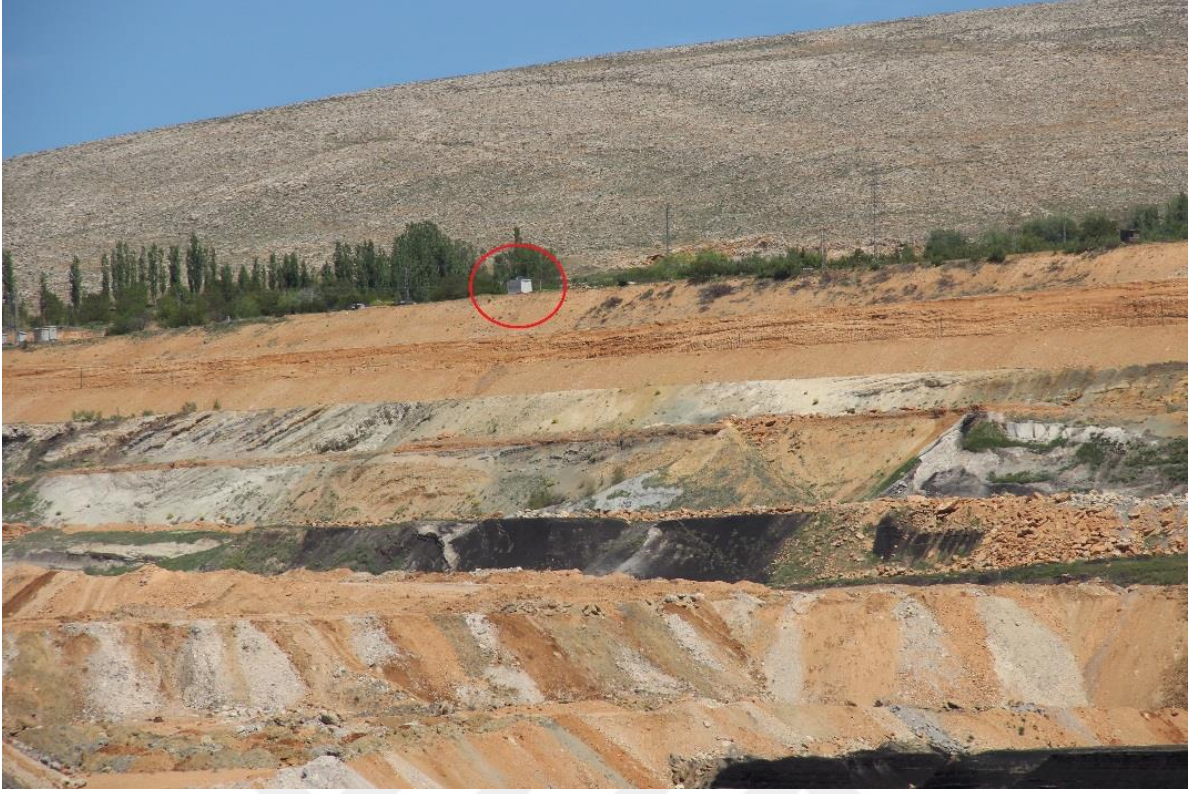
Şekil 5.4 Doğu nihai şevi üzerinde bulunan ve kırmızı daire ile gösterilen YB-InSAR cihazı.
