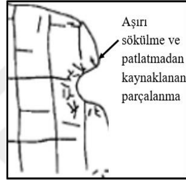
(d) Homojen eklemlili kayaç Aşırı sökülme veya patlatmaya bağlı kırıklar tarafından gevşetilmiş veya desteksiz kalmış bloklar
