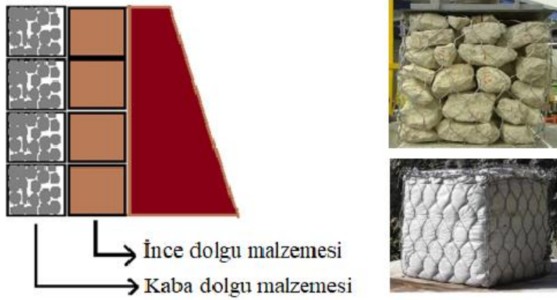
Şekil 6.4 Sedde tipi dolgu bariyer ve dolgu malzemeleri (Lambertl et al. 2008).
