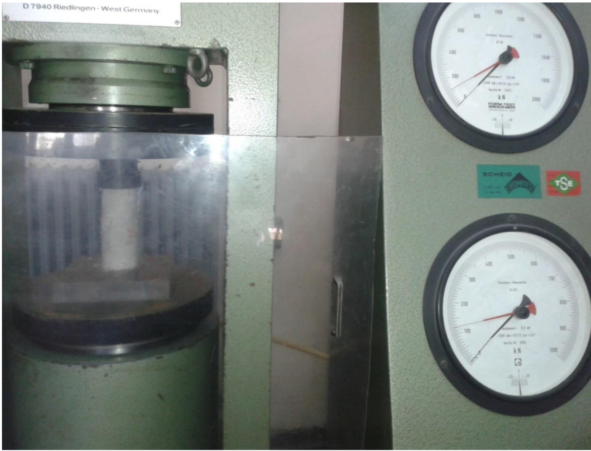
Şekil 4.3 Tek eksenli basınç dayanımı deneyi ve yükleme makinesi.
