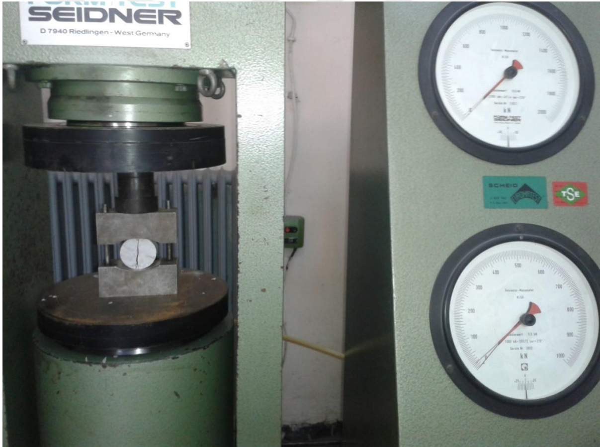
Şekil 4.4 Dolaylı çekme deneyinden görünüm.
