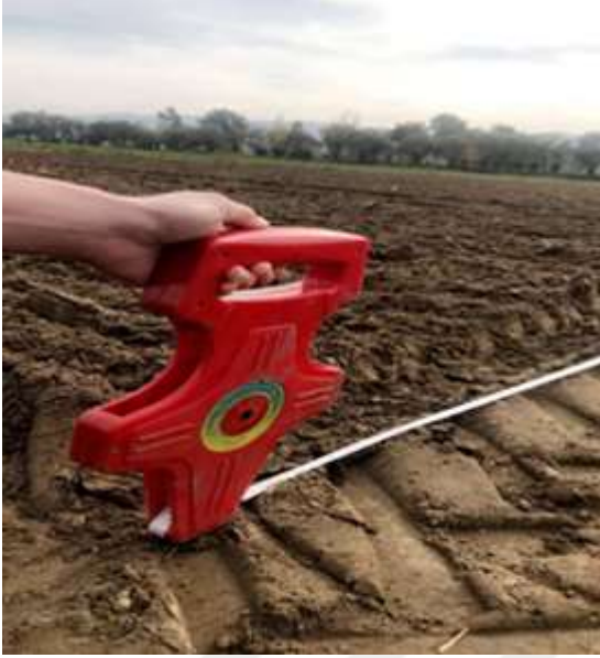
Şekil 3.2. Çelik şerit metre ile parsel alanlarının belirlenmesi
