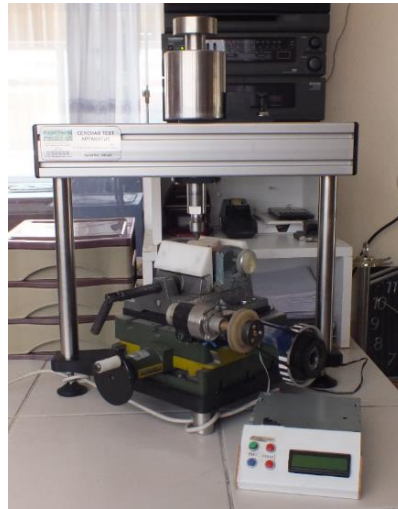
Şekil 4.19 West tam otomatik Cerchar aşınma indeksi deney aleti.
