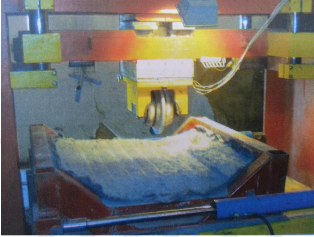
Şekil 3.3 CSM'de kullanılmış tam boyutlu kesme seti (Su 2010).
