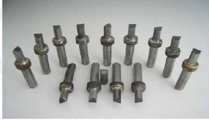
Şekil 2.14 SJ deneyinde kullanılan özel hazırlanmış uçlar.
