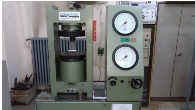
Şekil 4.12 Tek eksenli basınç ve dolaylı çekme dayanımı deneyinde kullanılan pres.
