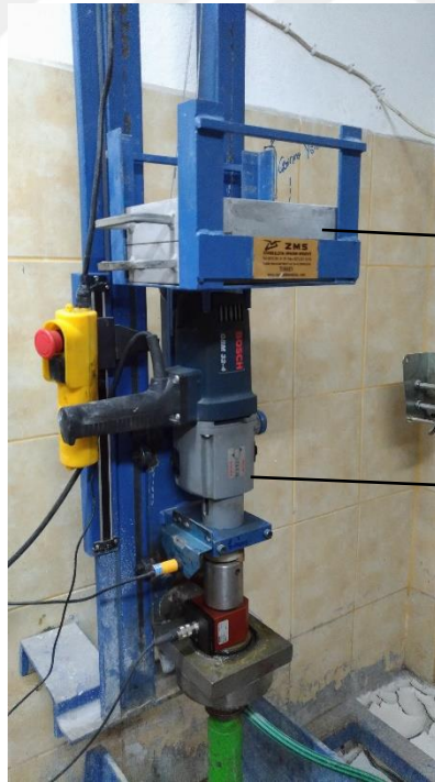
Şekil 4.4 Deney seti ait baskı yüğü için kefe
