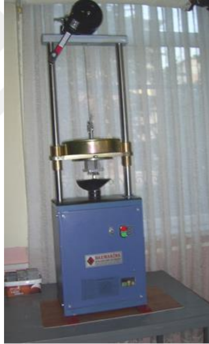
Şekil 2.12 Sievers minyatür delme (SJ) deney aletinin görünüşü (ZBEÜ).
