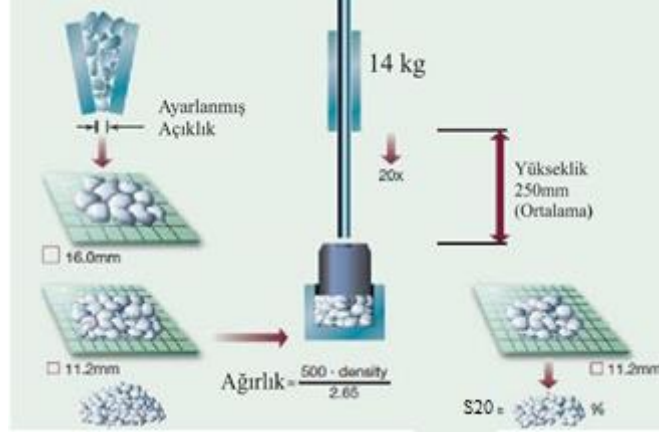
Şekil 2.9 Kırılmalık deney düzeneđi (Dahl 2003).
