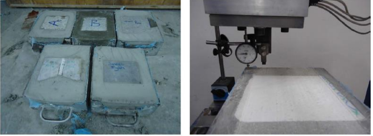
Şekil 3.7 Taşınabilir doğrusal kesme seti için hazırlanan örnekler ve deney öncesi yüzey düzeltilmesi (Tumaç vd. 2018).
