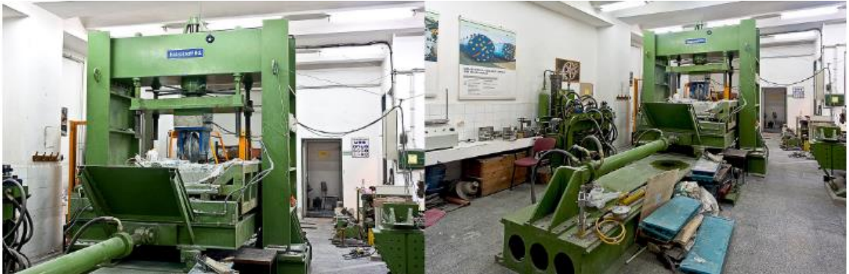
Şekil 3.4 İTÜ'de kullanılan tam boyutlu kesme seti (İTÜ 2018).
