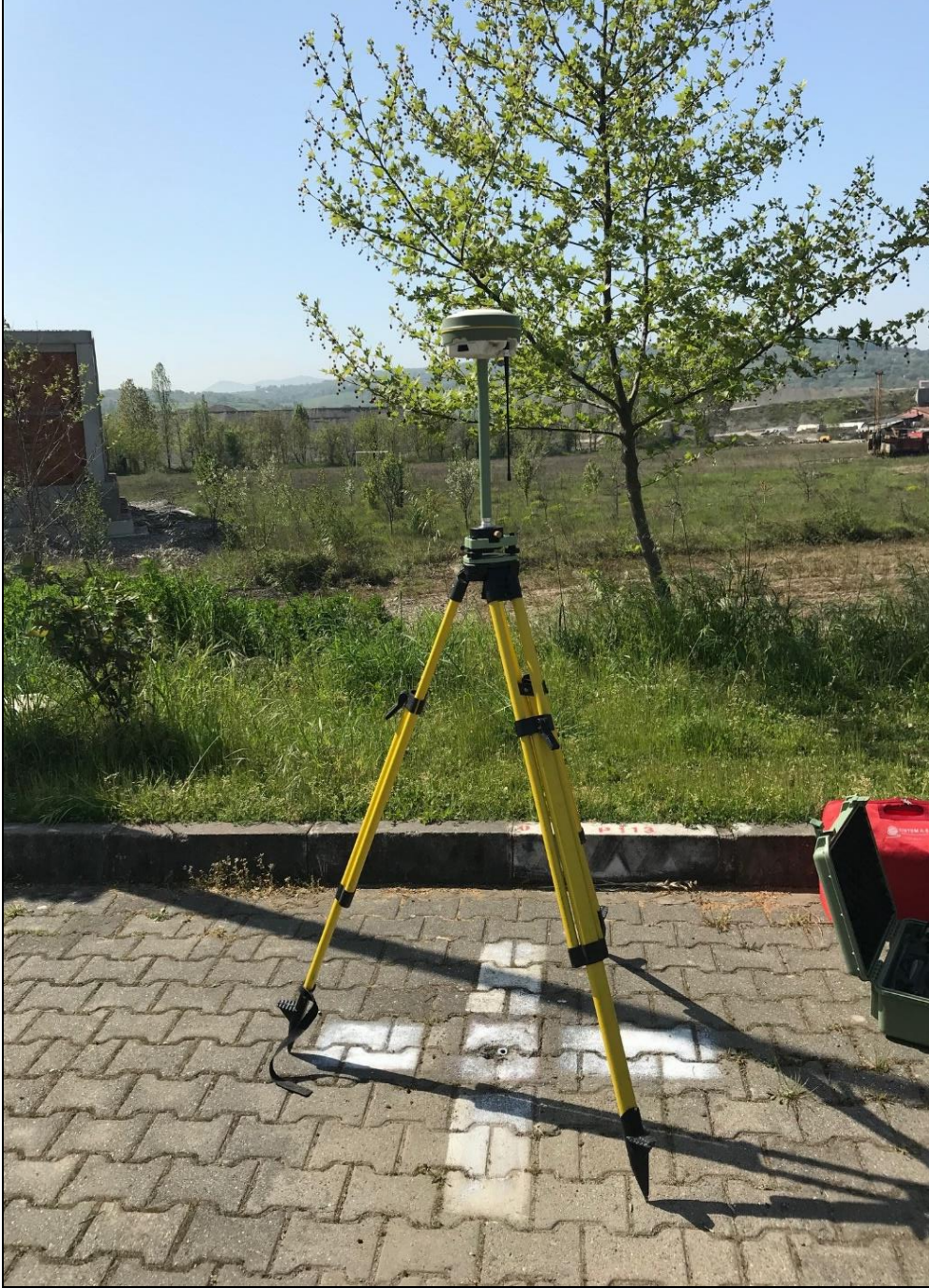
Şekil 4.3 SATLAB SL 6000 GNSS aleti YKN ölçümü.
