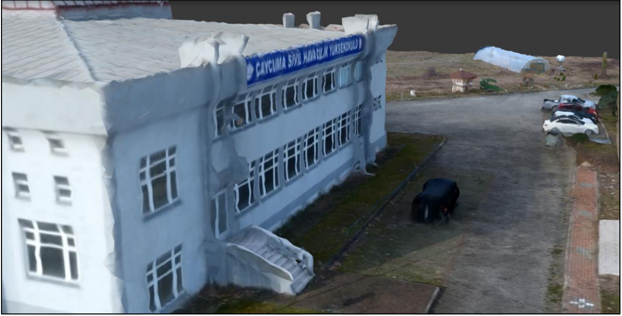
Şekil 5.7 Enterpolasyon etkisi saçak altlarında gözükmemektedir.
