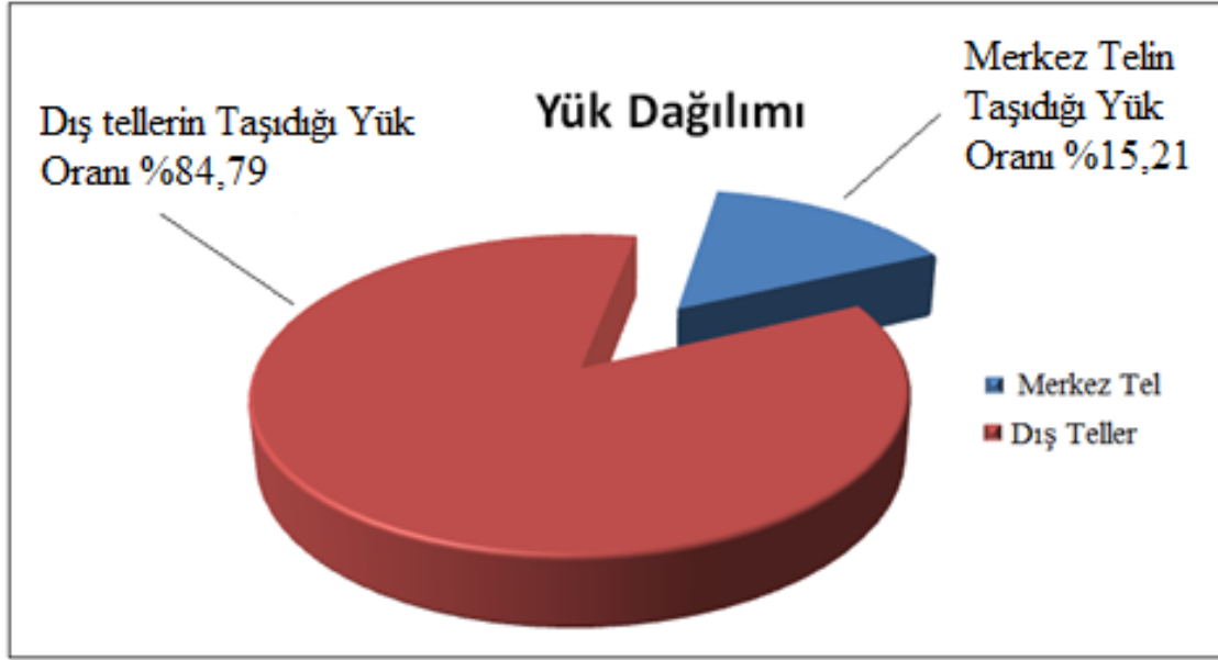
Şekil 5.2 Eksenel yükün merkez ve dış tellere dağılım oranları
